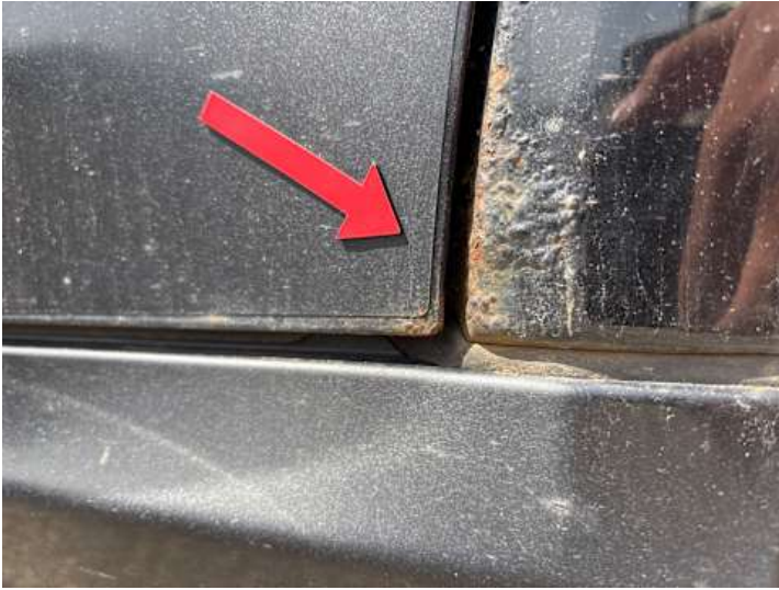
Türe hinten links (Rost)
