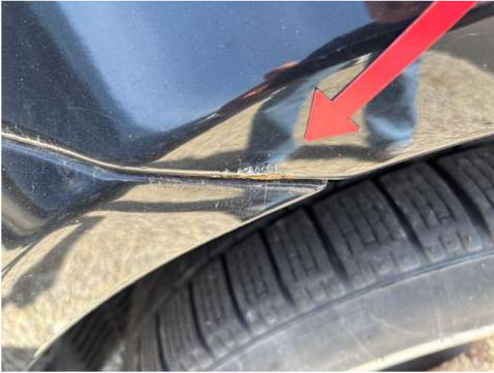
Seitenteil hinten rechts (Rost)
