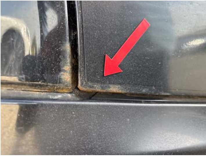
Türe hinten rechts (Rost)
