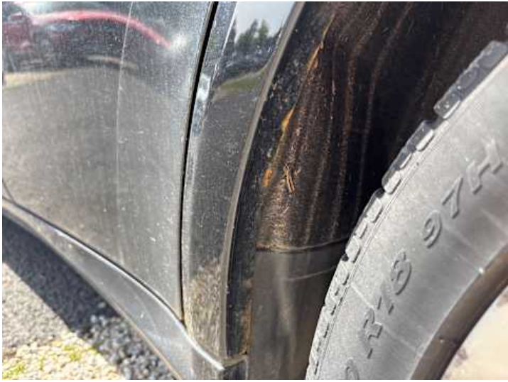
Seitenteil hinten links (Rost)
