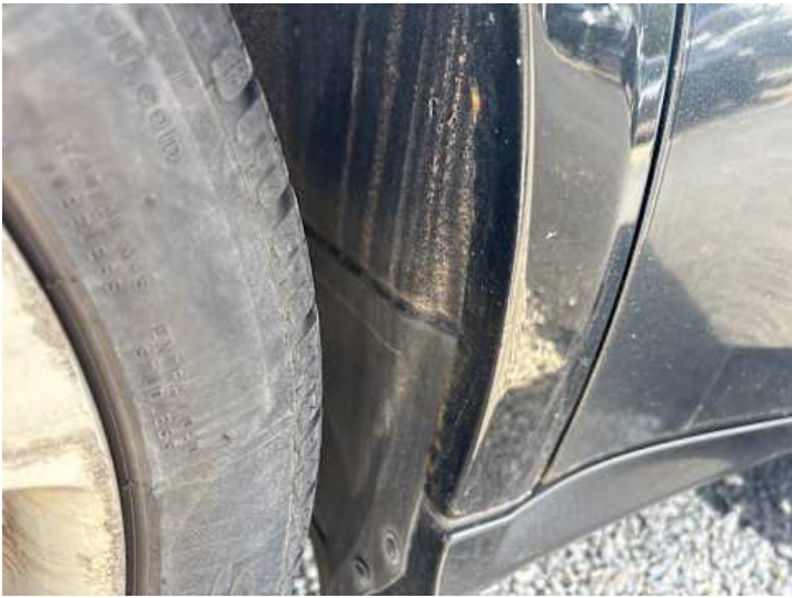
Seitenteil hinten rechts (Rost)
