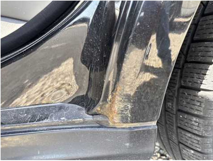
Seitenteil hinten links (Rost)
