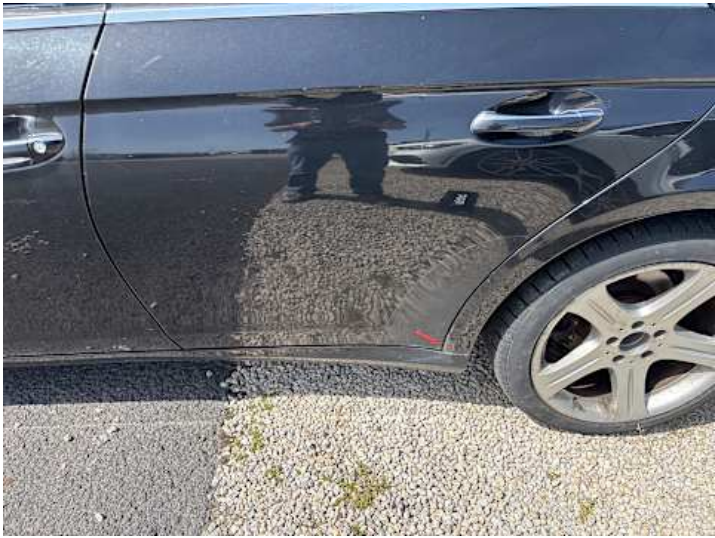
Türe hinten links (Rost)
