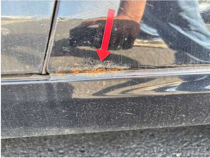
Kotflügel vorne rechts (Rost)
