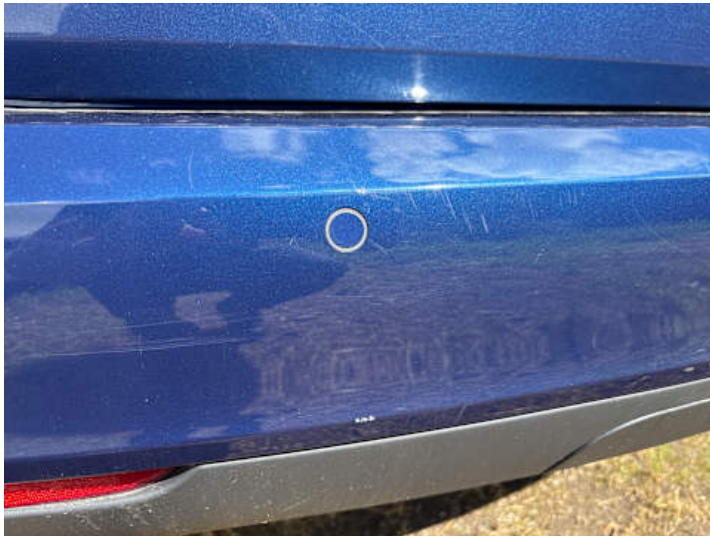
Stoßstange hinten (Kratzer)
