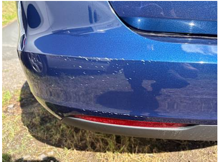
Stoßstange hinten (Kratzer)
