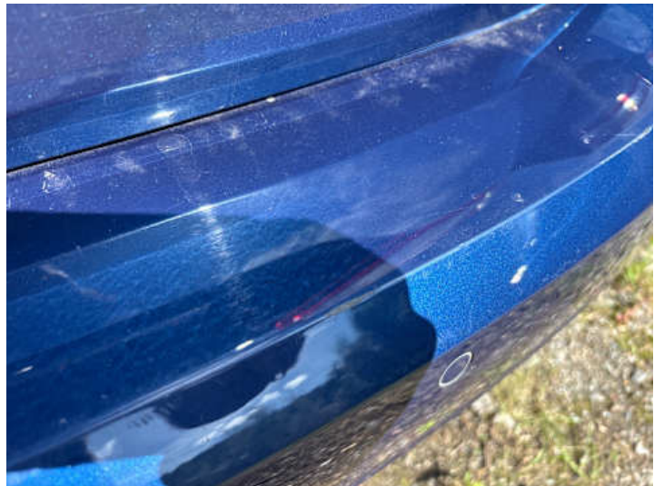
Stoßstange hinten (Kratzer)
