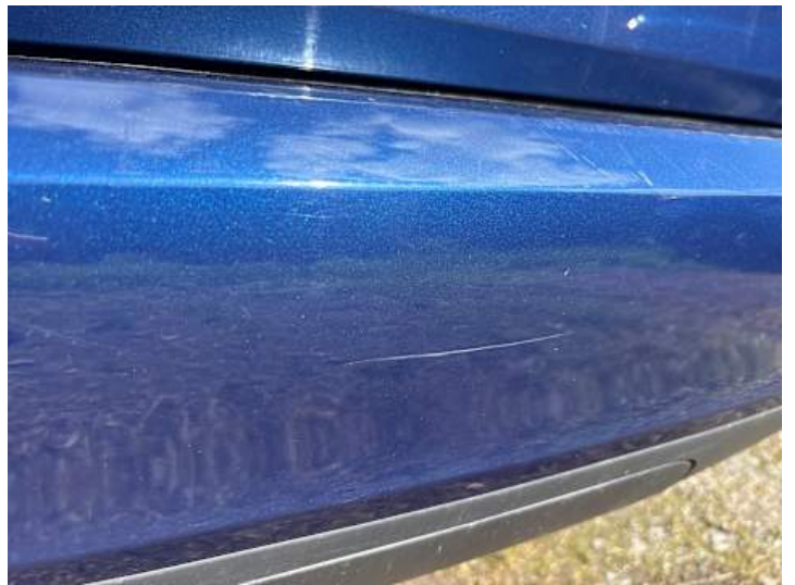
Stoßstange hinten (Kratzer)
