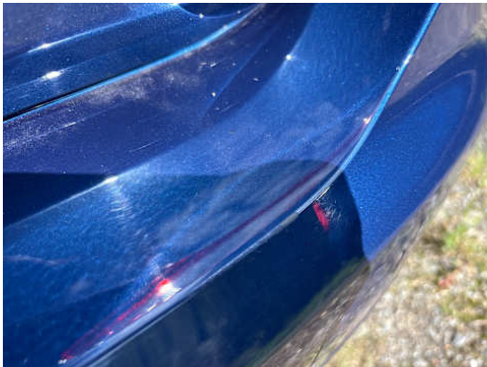
Stoßstange hinten (Kratzer)
