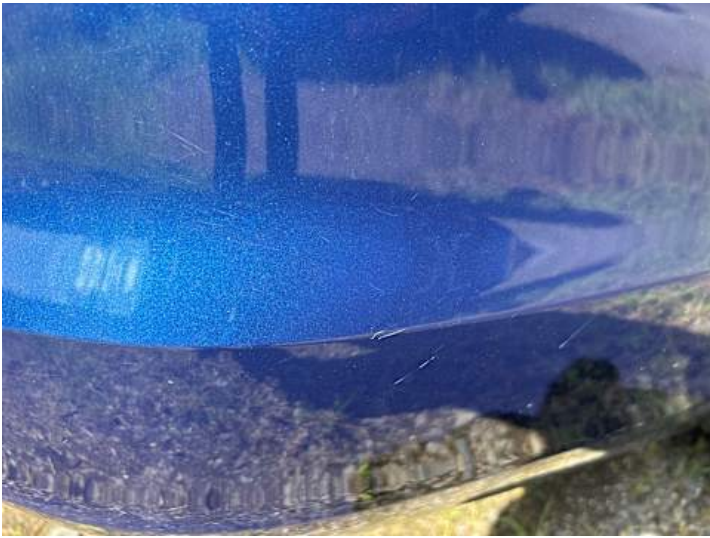
Stoßstange hinten (Kratzer)
