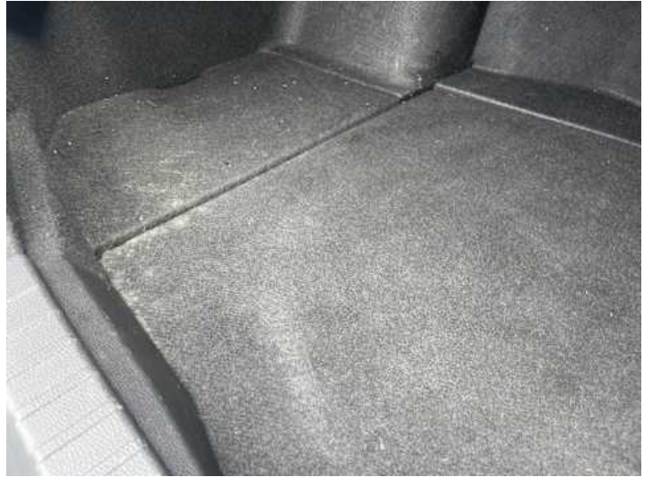
Innenraum (Anderer Schaden): Schimmel
