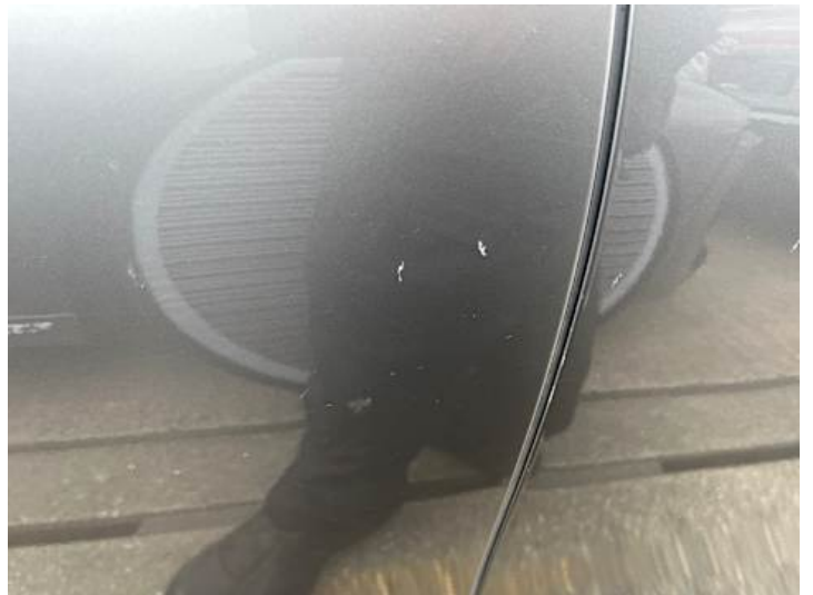
Türe hinten rechts (Kratzer, Lackschaden)
