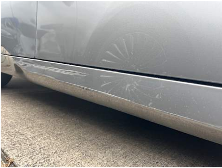
Schweller rechts (Kratzer, Lackschaden)
