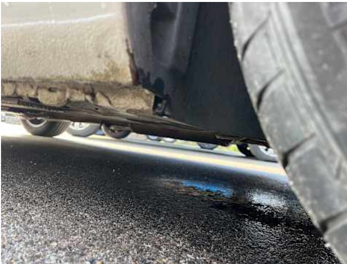
Schweller rechts (Lackschaden, Steinschlag)
