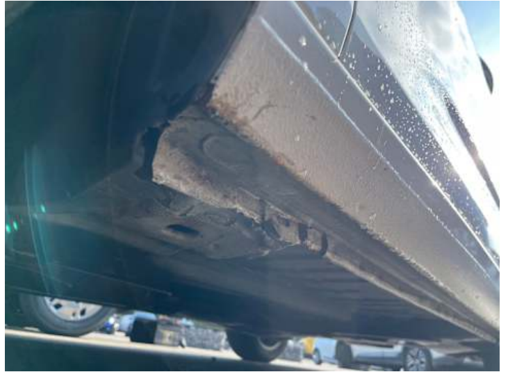
Schweller links (Lackschaden, Steinschlag)
