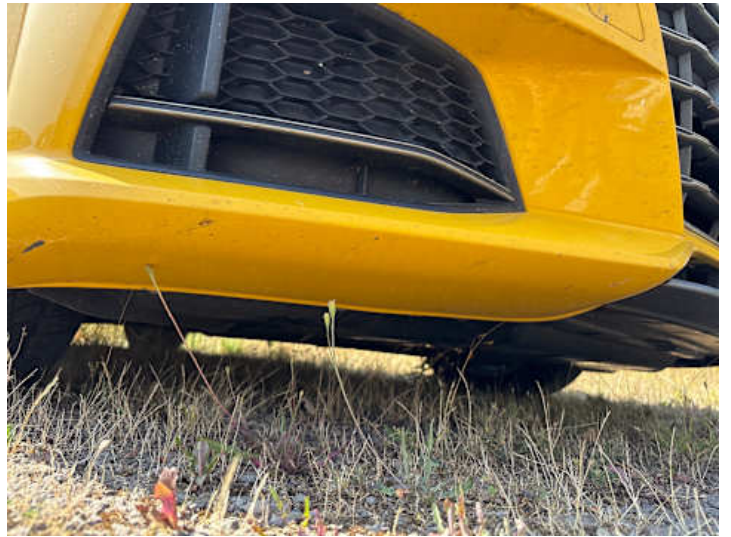
Stoßstange vorne (Kratzer, Steinschlag)
