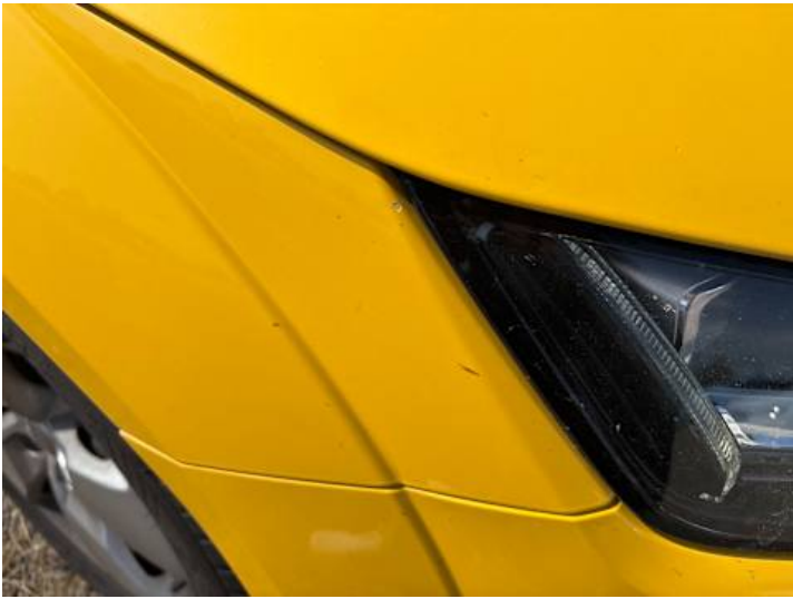
Kotflügel vorne rechts (Steinschlag)
