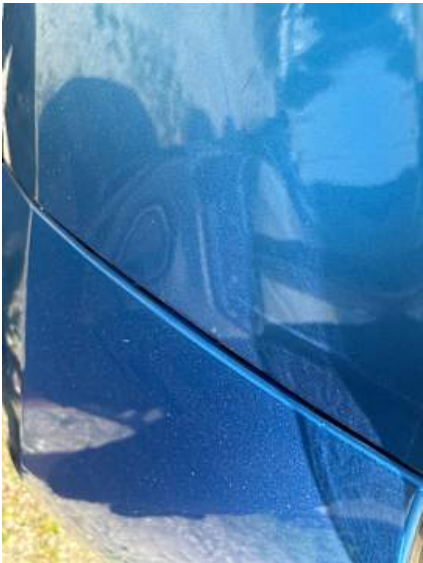
Stoßstange hinten (Spaltmaße ungenau, Riss/Bruch)
