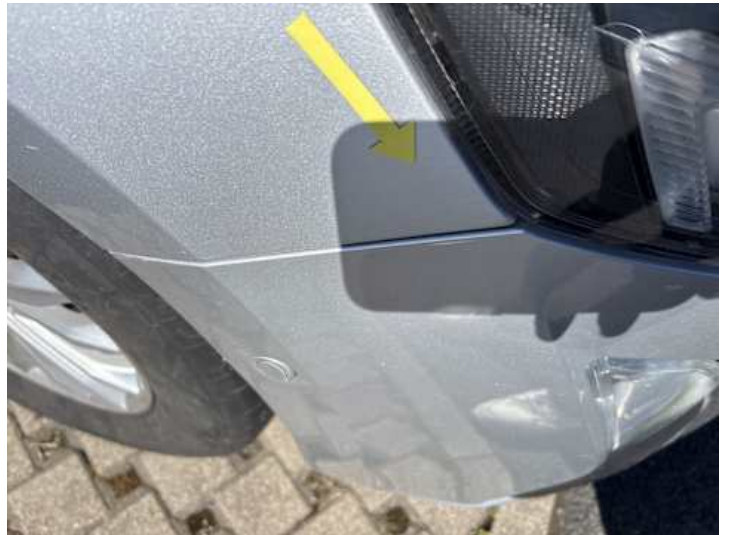
Stoßstange vorne (Spaltmaße ungenau)
