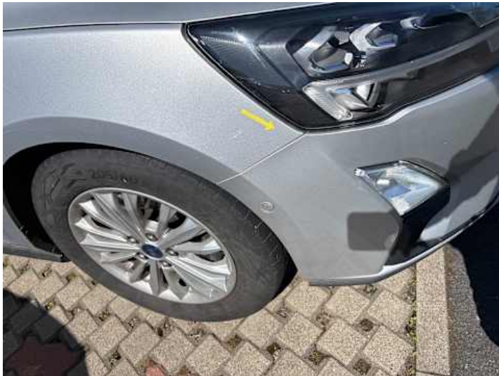
Stoßstange vorne (Spaltmaße ungenau)
