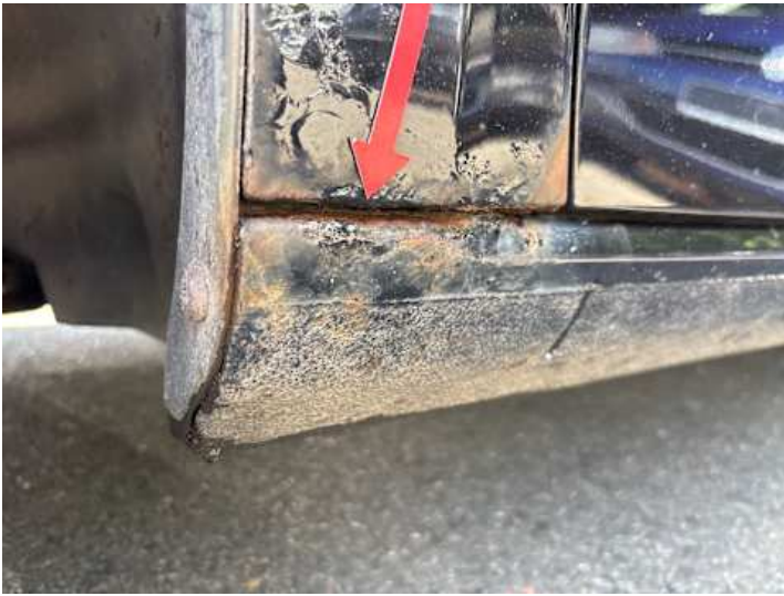
Schweller links (Rost)
