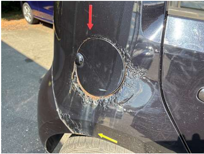
Seitenteil hinten rechts (Rost)
