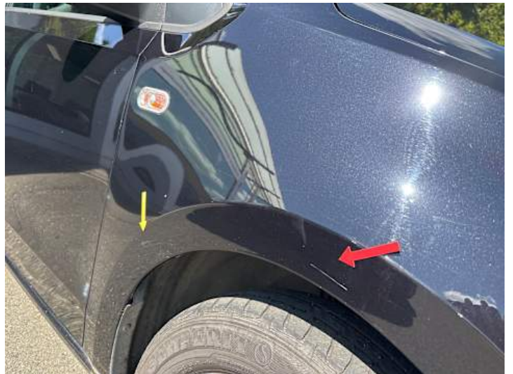
Kotflügel vorne rechts (Kratzer)
