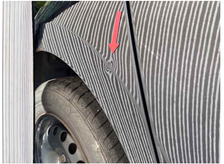
Seitenteil hinten rechts (Delle)
