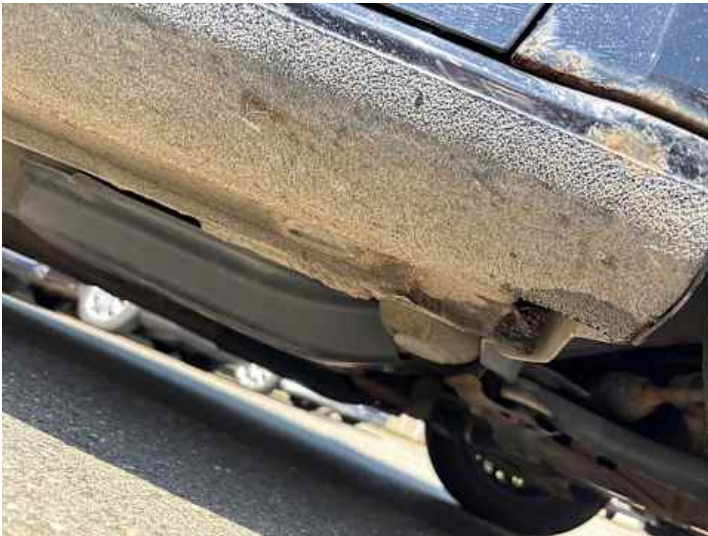
Schweller rechts (Rost, Verformung)
