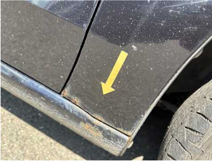
Kotflügel vorne rechts (Rost)
