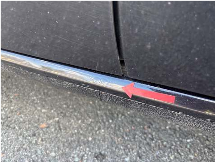
Schweller links (Rost)
