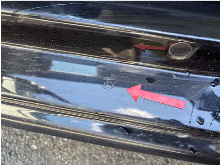
Schweller links (Rost)
