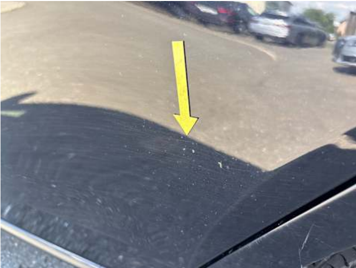
Türe hinten links (Rost)
