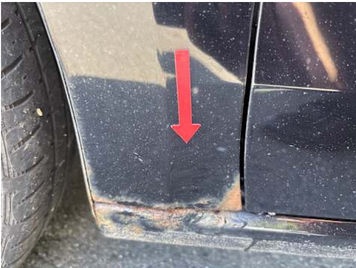
Kotflügel vorne links (Rost)
