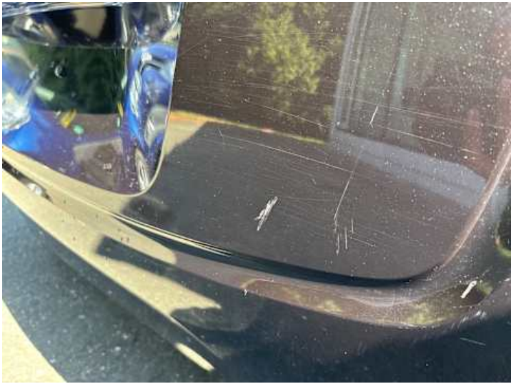
Stoßstange hinten (Kratzer, Lackschaden)
