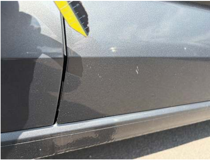
Beifahrertür (Lackschaden, Kratzer)
