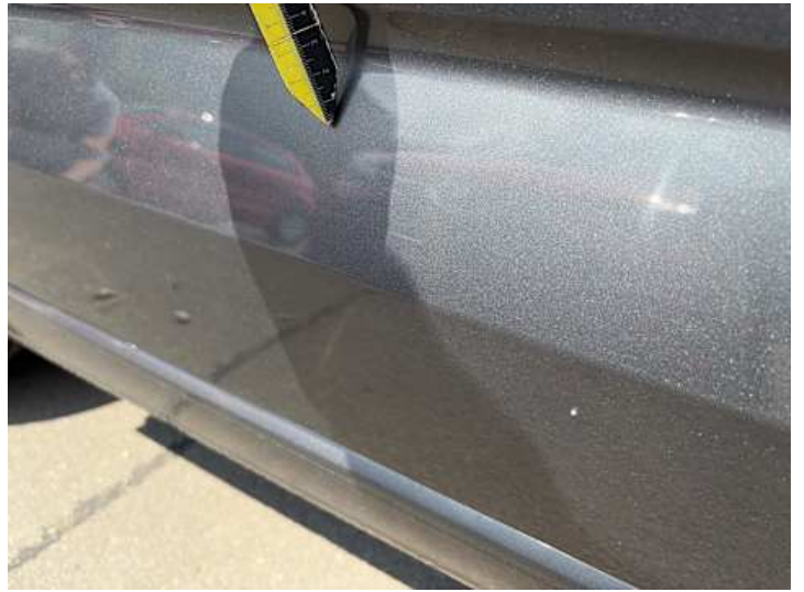
Türe hinten rechts (Lackschaden, Kratzer, Verformung, Delle)
