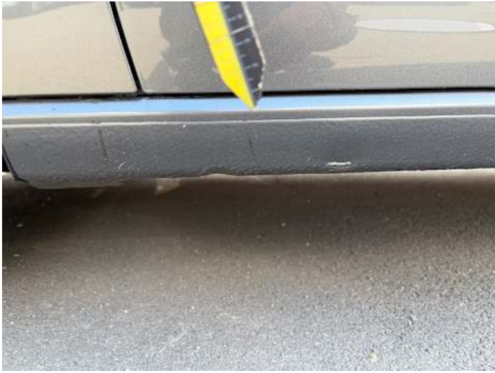
Schweller links (Lackschaden, Kratzer, Verformung)
