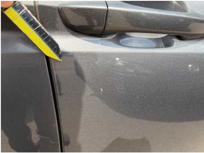
Beifahrertür (Lackschaden, Kratzer)
