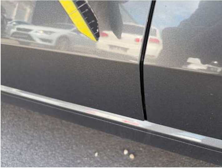
Fahrtür (Lackschaden, Kratzer)
