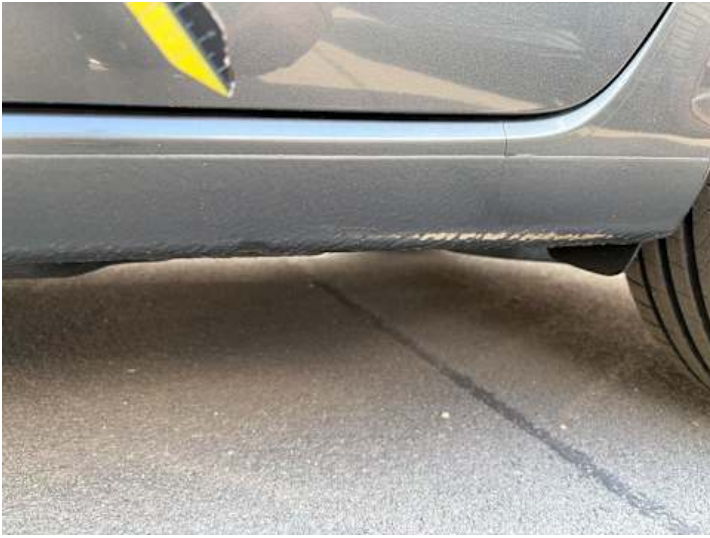
Schweller links (Lackschaden, Kratzer, Verformung)
