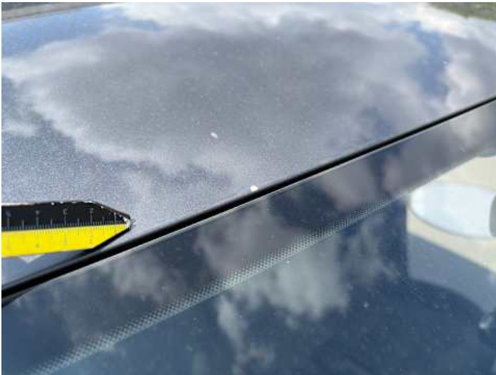
Dach (Lackschaden, Steinschlag)
