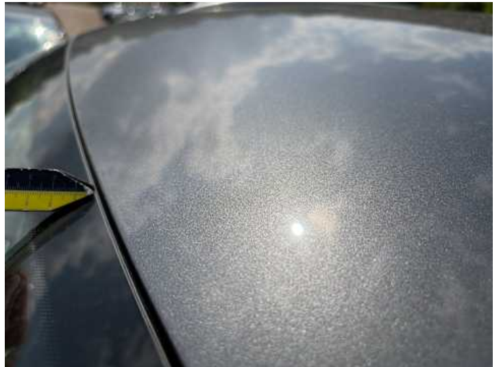
Dach (Lackschaden, Steinschlag)
