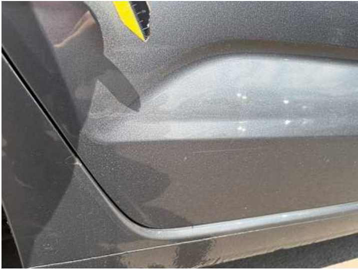
Türe hinten rechts (Lackschaden, Kratzer, Verformung, Delle)
