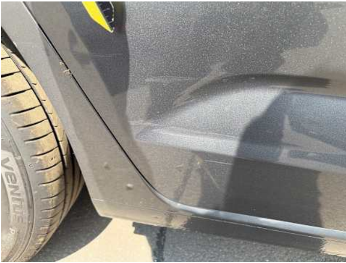
Türe hinten rechts (Lackschaden, Kratzer, Verformung, Delle)
