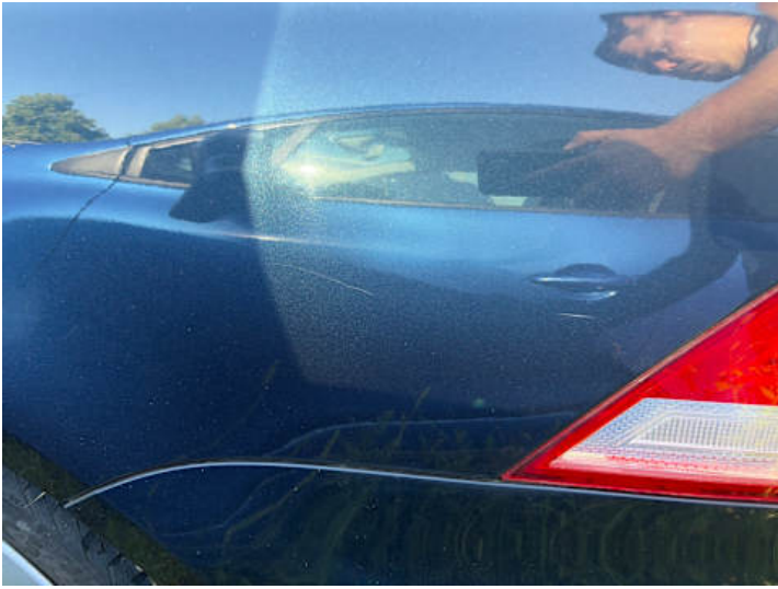
Seitenteil hinten links (Kratzer)
