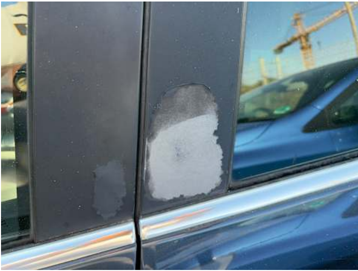
Türe hinten links (Lackschaden)
