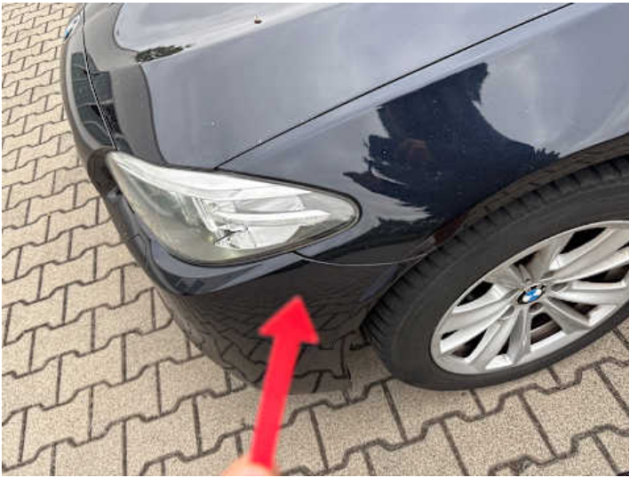
Stoßstange vorne (Spaltmaße ungenau)
