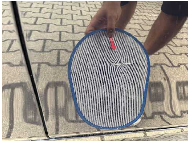
Fahrertür (Delle, Kratzer)
