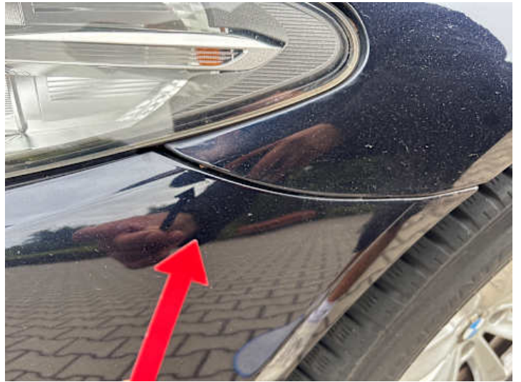
Stoßstange vorne (Spaltmaße ungenau)
