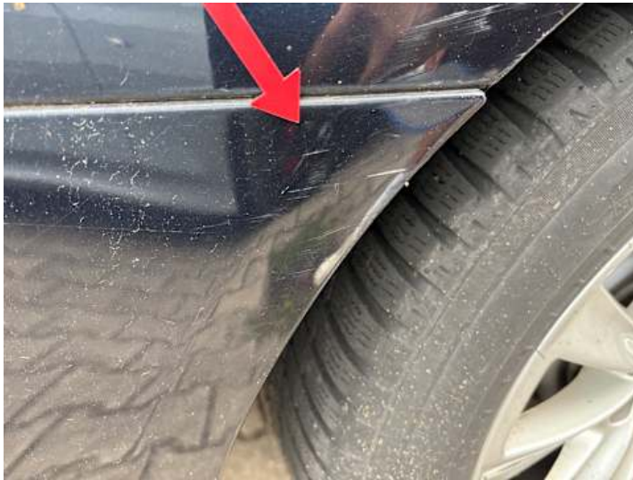
Stoßstange hinten (Kratzer)
