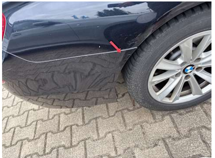
Stoßstange hinten (Kratzer)
