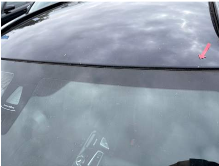
Dach (Steinschlag, Lackschaden)
