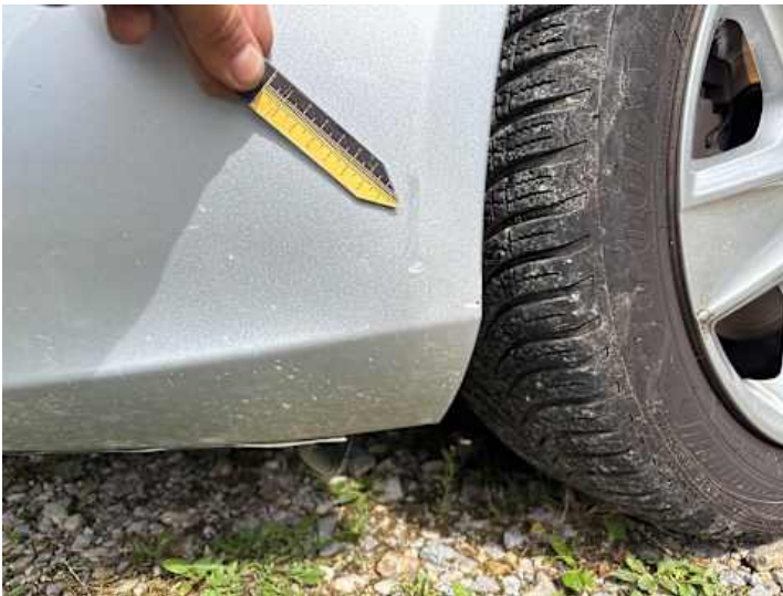
Stoßstange vorne (Lackschaden, Kratzer)
