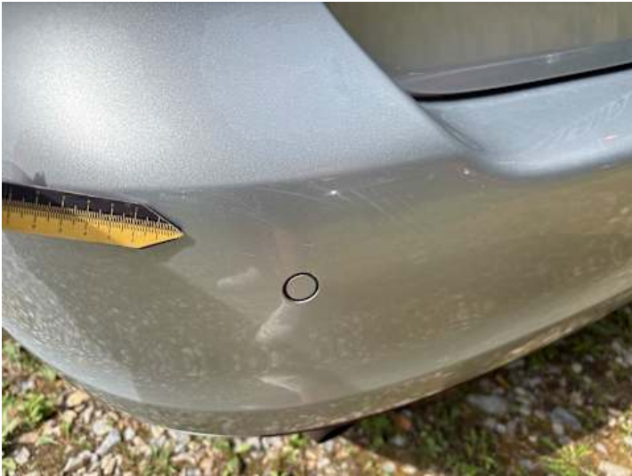
Stoßstange hinten (Lackschaden)
