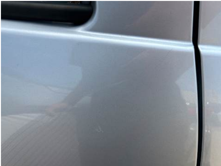
Türe hinten rechts (Kratzer, Lackschaden)
