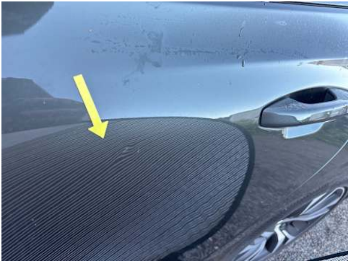
Türe hinten links (Delle, Lackschaden)
