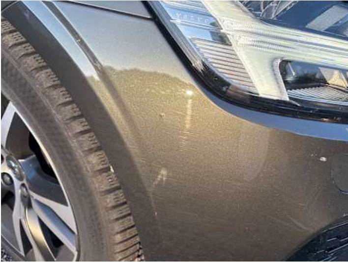
Stoßstange vorne (Kratzer, Lackschaden)
