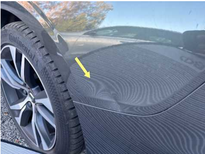
Seitenteil hinten links (Delle, Verformung)
