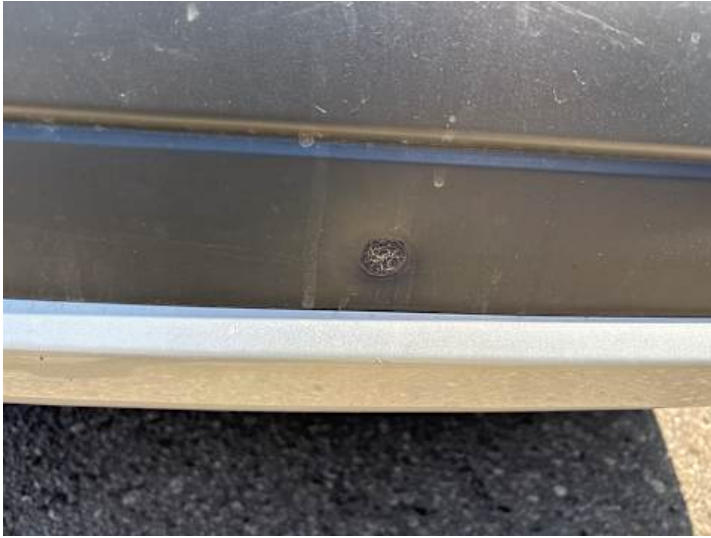
Stoßstange hinten (Riss/Bruch, Unsachgemäß instand gesetzt)
