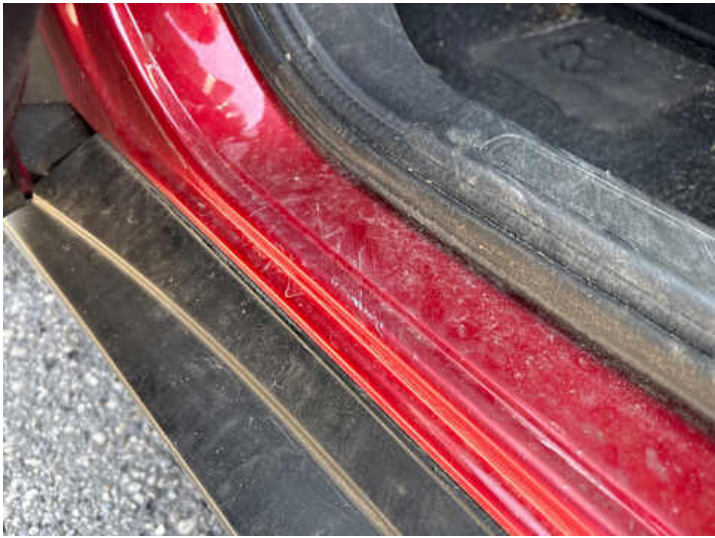
Schweller links (Kratzer)
