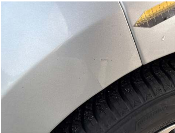
Stoßstange hinten (Riss/Bruch, Lackschaden)
