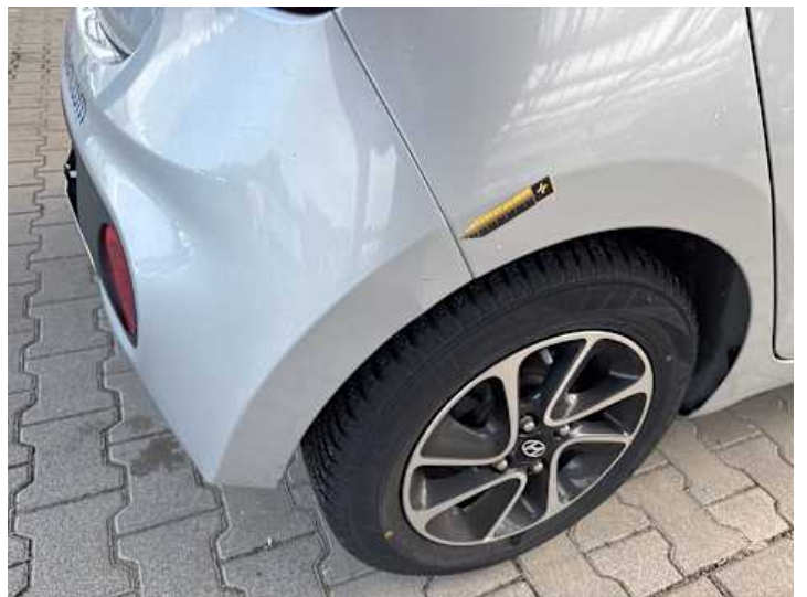
Stoßstange hinten (Riss/Bruch, Lackschaden)
