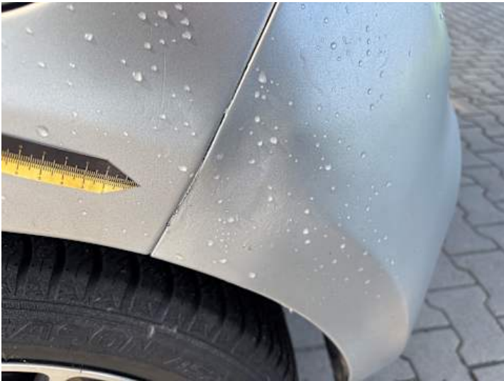
Seitenteil hinten links (Unsachgemäß instand gesetzt, Spaltmaße ungenau, Lackschaden)
