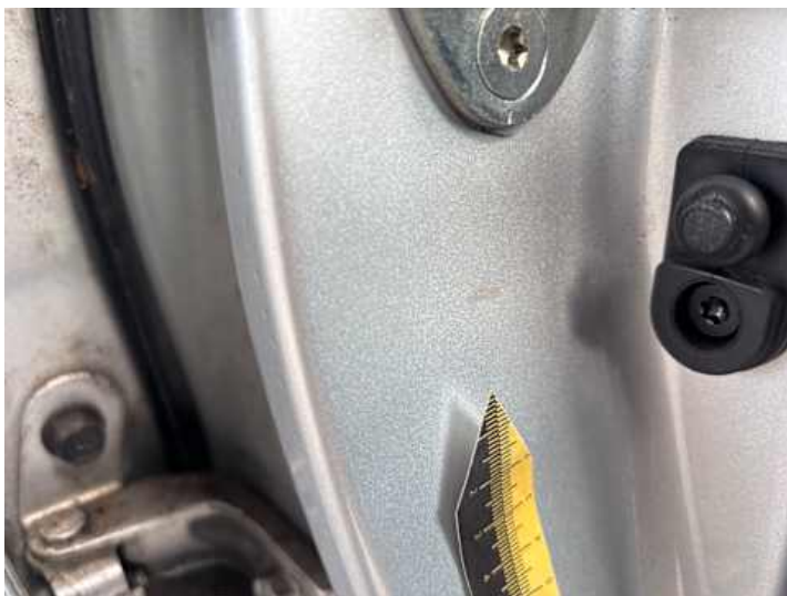
Schweller rechts (Lackschaden)
