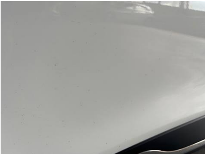
Türe hinten rechts (Anderer Schaden): Flugrost
