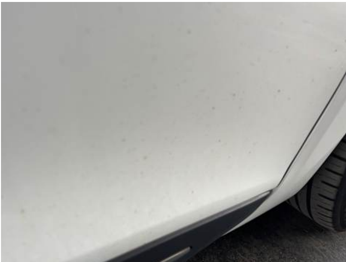
Beifahrertür (Anderer Schaden): Flugrost
