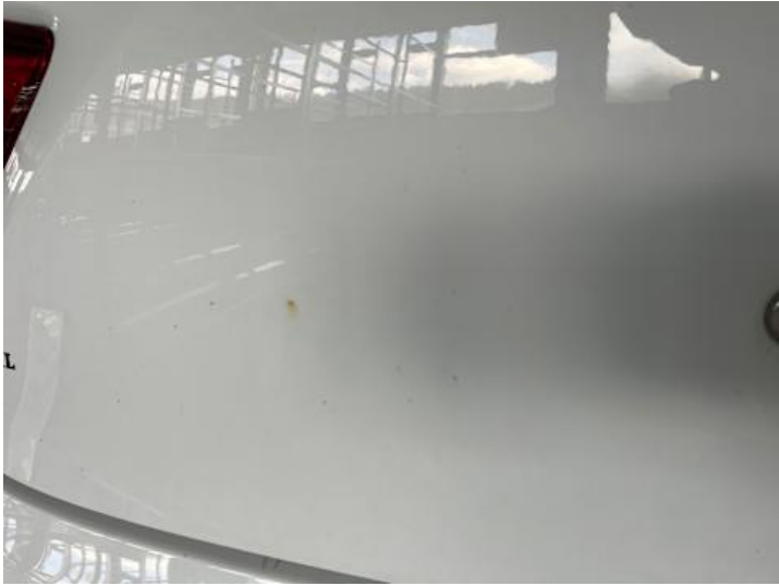
Heckklappe (Anderer Schaden): Flugrost
