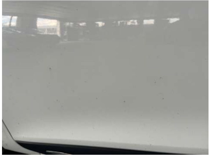
Fahrertür (Anderer Schaden): Flugrost
