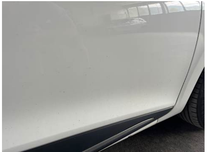
Beifahrertür (Anderer Schaden): Flugrost
