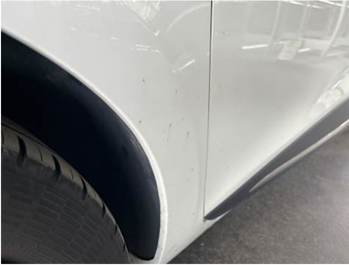
Kotflügel vorne links (Anderer Schaden): Flugrost
