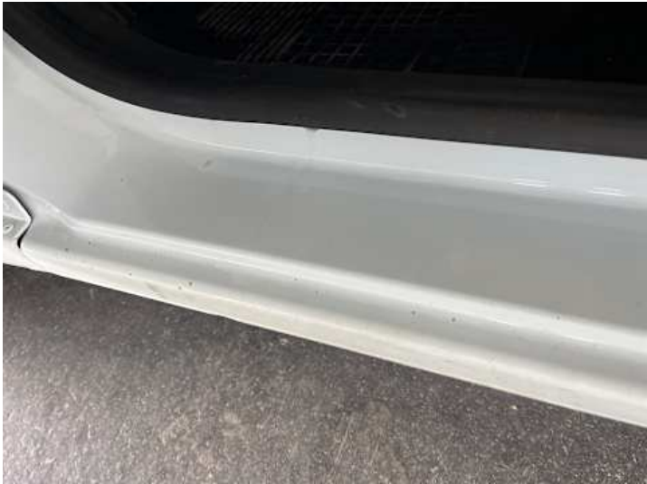
Schweller links (Kratzer, Anderer Schaden): Flugrost
