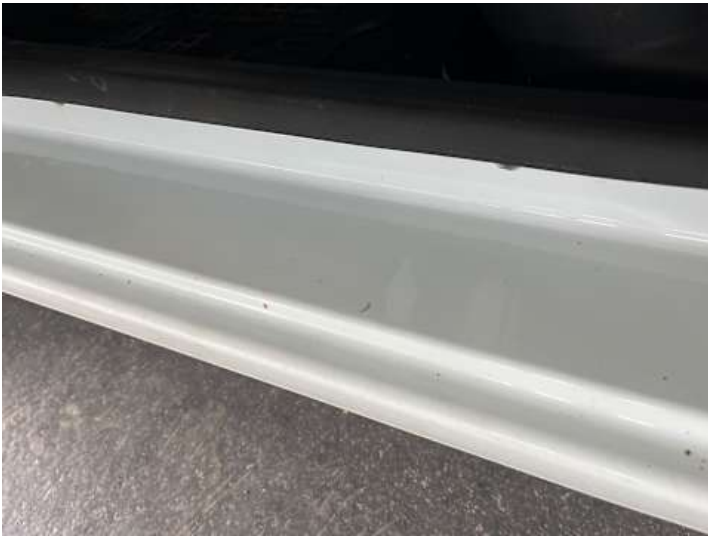
Schweller links (Kratzer, Anderer Schaden): Flugrost
