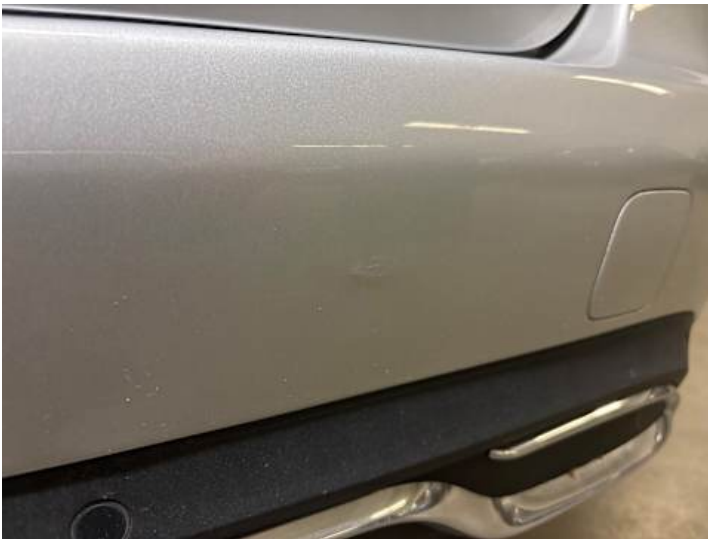
Stoßstange hinten (Lackschaden, Unsachgemäß instand gesetzt)
