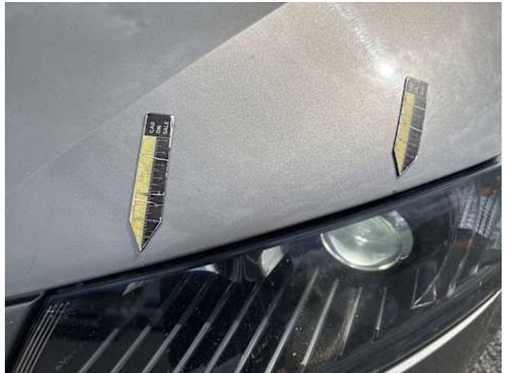
Motorhaube (Lackschaden, Rost, Unsachgemäß instand gesetzt)
