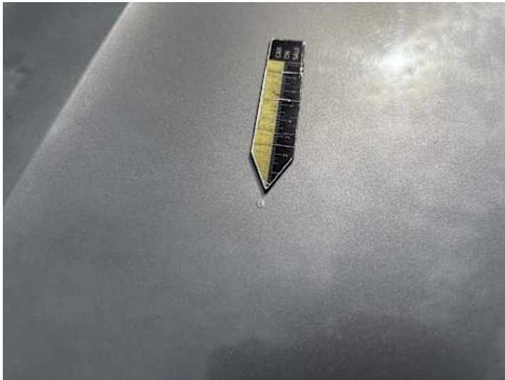
Motorhaube (Lackschaden, Rost, Unsachgemäß instand gesetzt)
