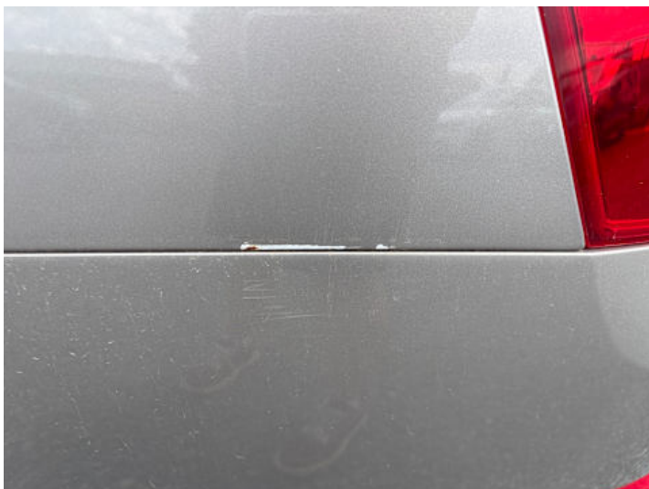
Seitenteil hinten links (Kratzer, Rost)
