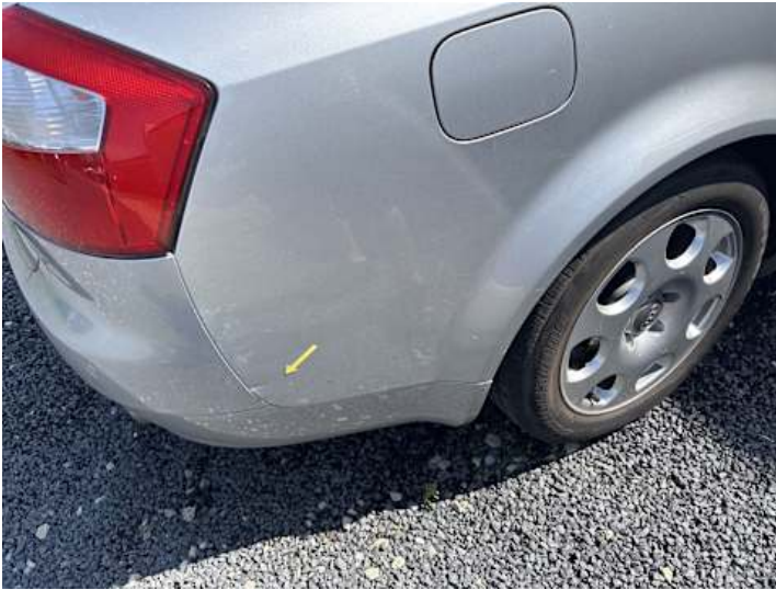
Seitenteil hinten rechts (Delle, Kratzer, Unsachgemäß instand gesetzt)
