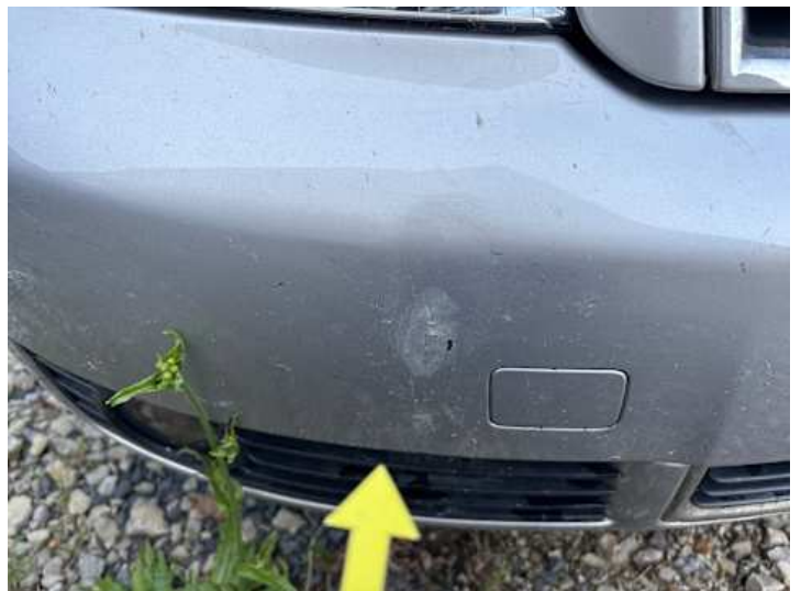
Stoßstange vorne (Riss/Bruch, Unsachgemäß instand gesetzt)
