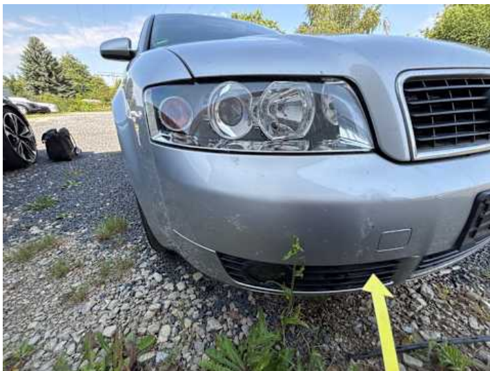
Stoßstange vorne (Riss/Bruch, Unsachgemäß instand gesetzt)
