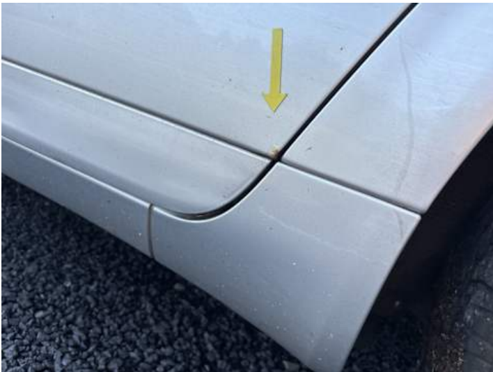
Türe hinten links (Rost)
