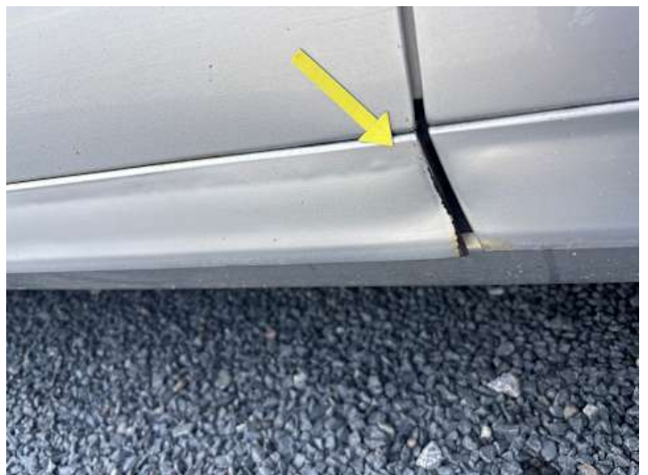
Fahrtür (Rost, Kratzer)
