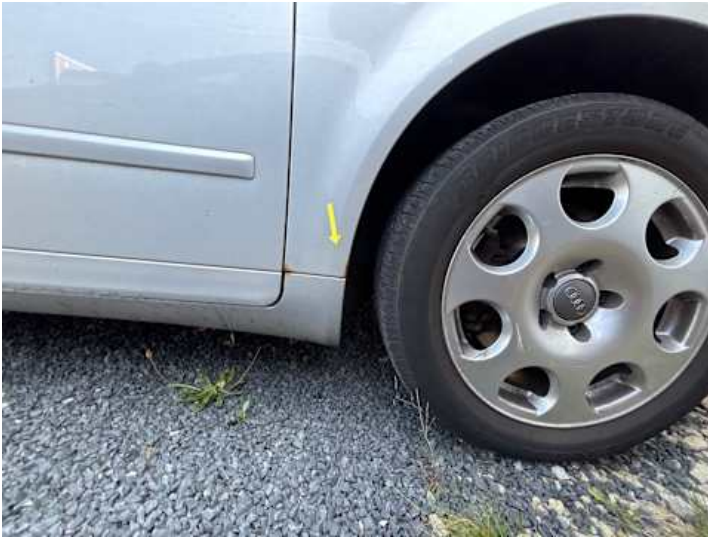
Kotflügel vorne rechts (Rost)
