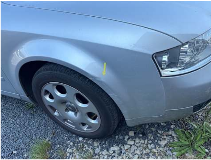
Kotflügel vorne rechts (Verformung, Unsachgemäß instand gesetzt, Lackschaden)
