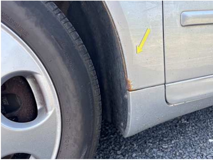
Kotflügel vorne links (Rost)
