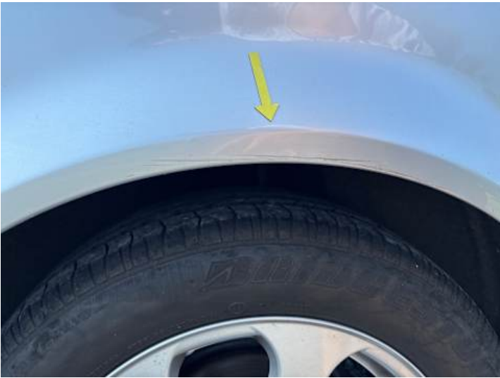
Seitenteil hinten links (Kratzer)
