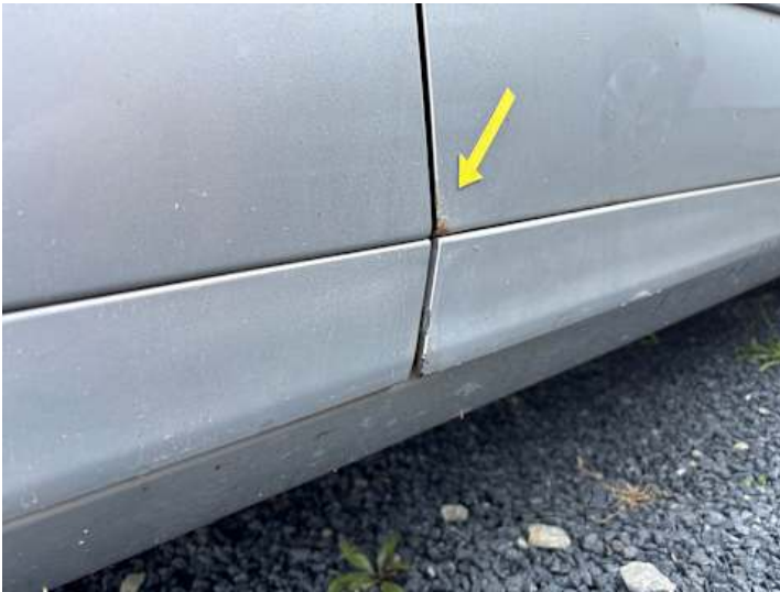
Beifahrtür (Rost, Kratzer)
