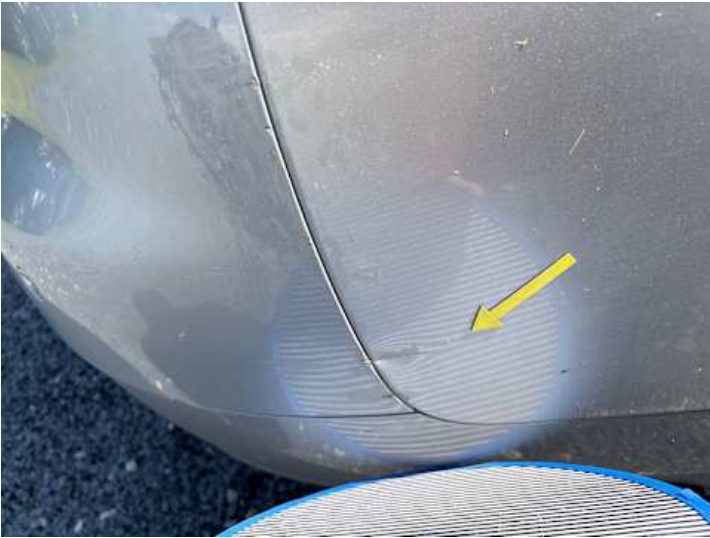
Seitenteil hinten rechts (Delle, Kratzer, Unsachgemäß instand gesetzt)
