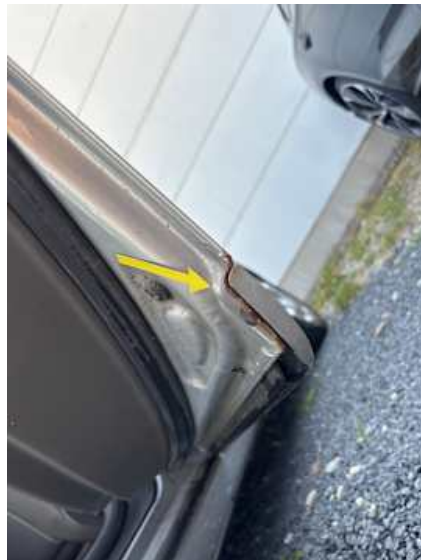
Türe hinten rechts (Rost)
