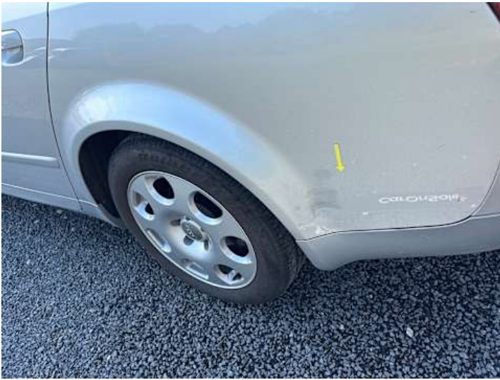
Seitenteil hinten links (Kratzer, Unsachgemäß instand gesetzt, Delle)
