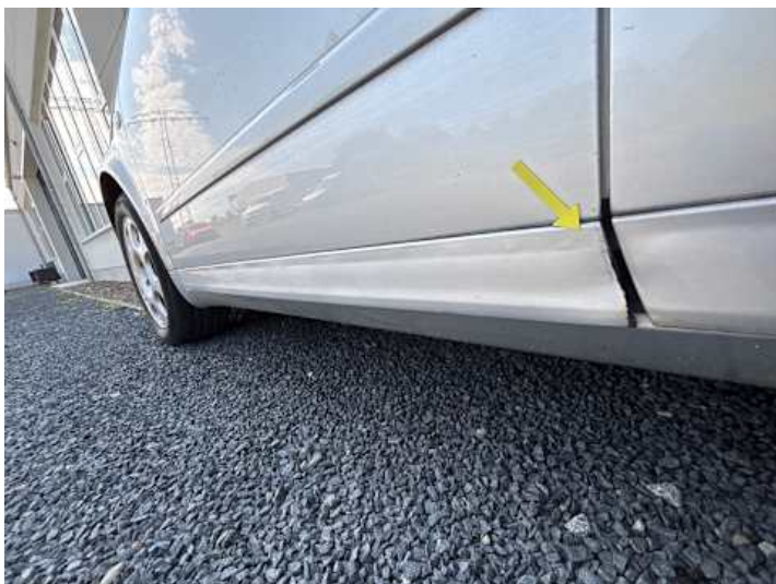
Fahrtür (Rost, Kratzer)
