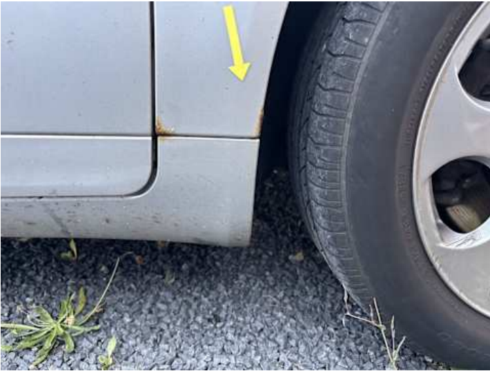
Kotflügel vorne rechts (Rost)
