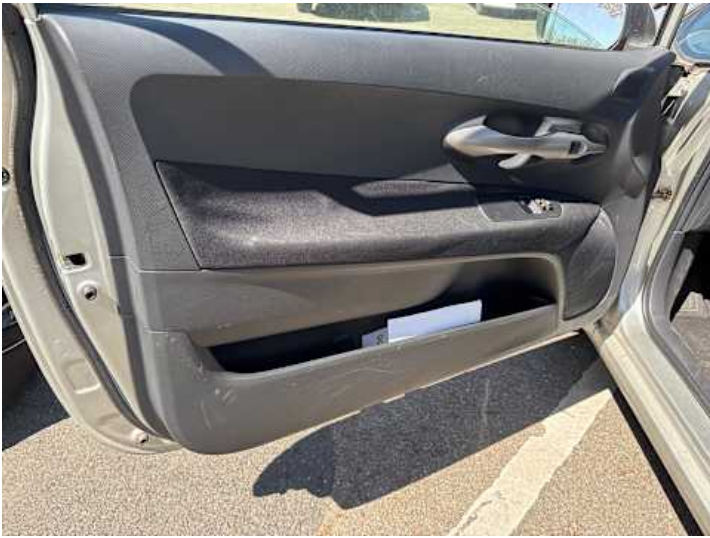
Innenraum (Diverse Schäden, Kratzer, Verschmutzung)
