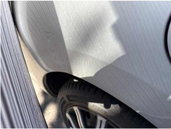
Seitenteil hinten links (Kratzer, Verformung)
