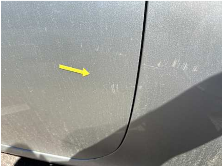
Fahrtür (Kratzer, Delle)
