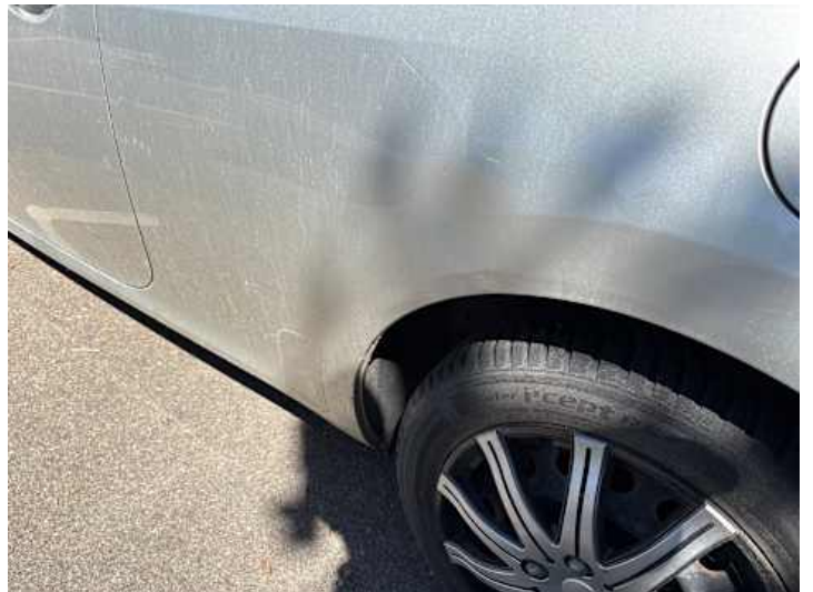
Seitenteil hinten links (Kratzer, Verformung)
