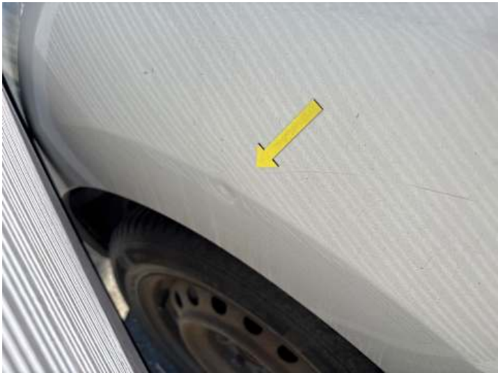
Seitenteil hinten rechts (Delle, Kratzer)
