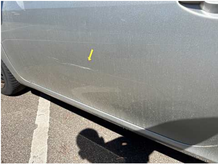
Fahrtür (Kratzer, Verformung)
