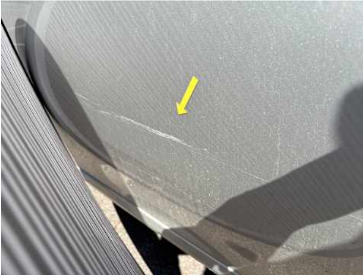
Fahrtür (Kratzer, Verformung)
