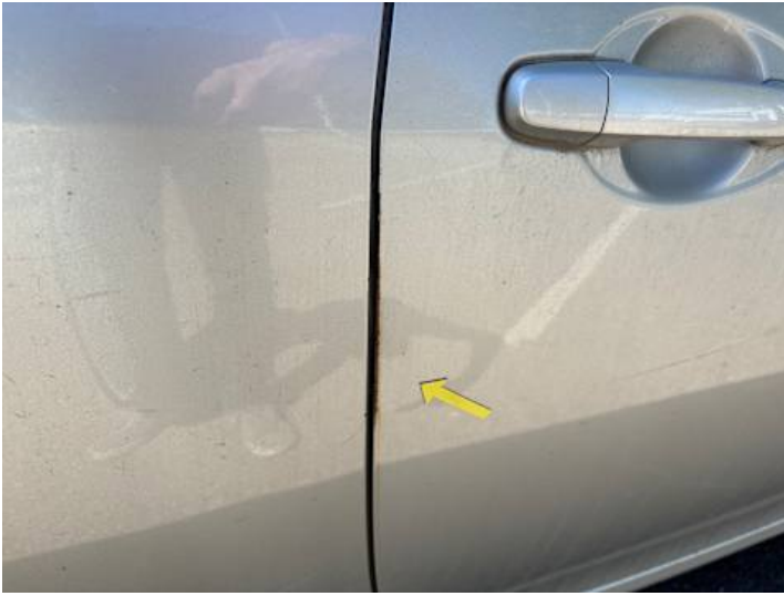
Beifahrtür (Kratzer, Rost)
