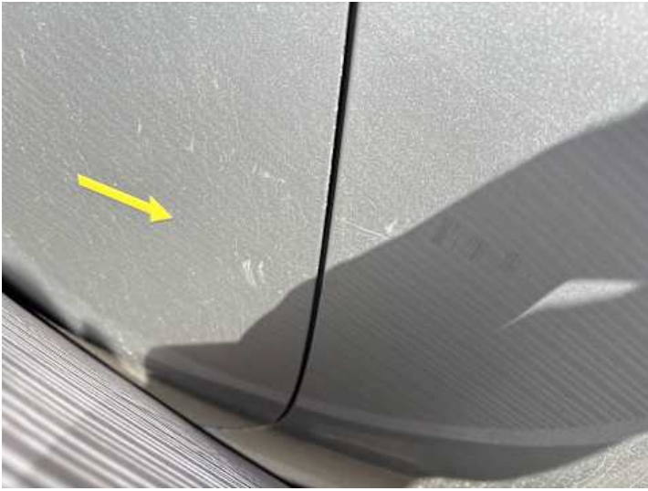
Fahrtür (Kratzer, Delle)
