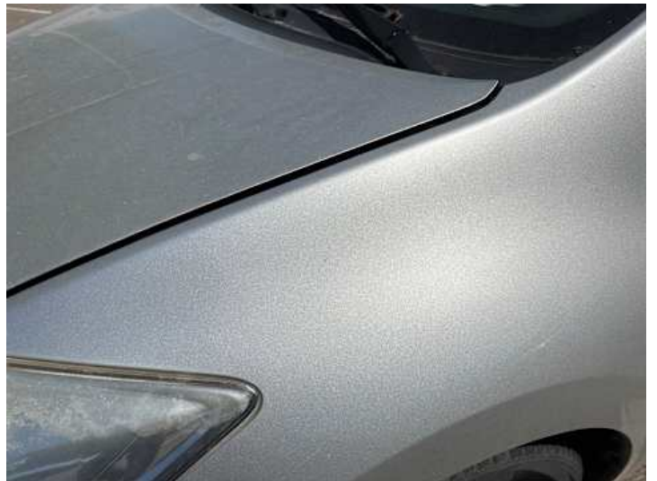
Motorhaube (Verformung, Spaltmaße ungenau)
