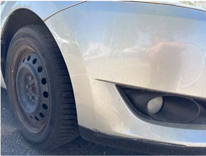
Stoßstange vorne (Kratzer, Lackschaden)
