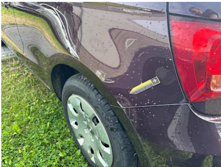
Seitenteil hinten links (Verformung)
