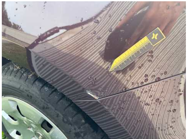
Seitenteil hinten links (Verformung)
