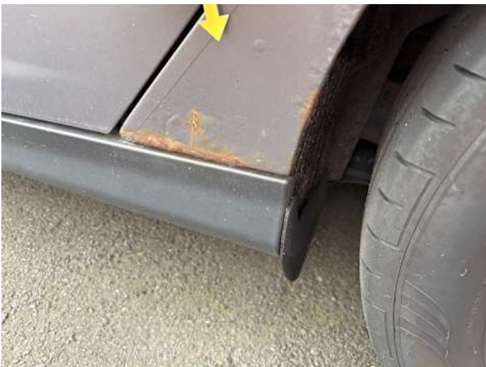
Seitenteil hinten links (Rost)
