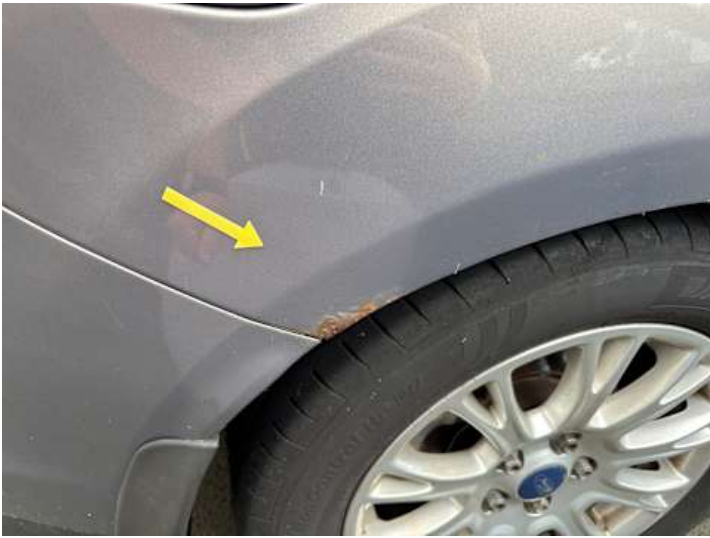
Seitenteil hinten rechts (Rost)
