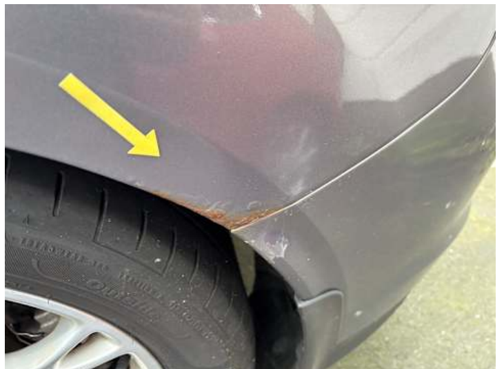
Seitenteil hinten links (Rost)
