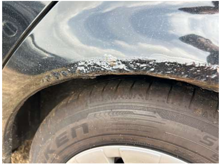
Seitenteil hinten links (Rost)
