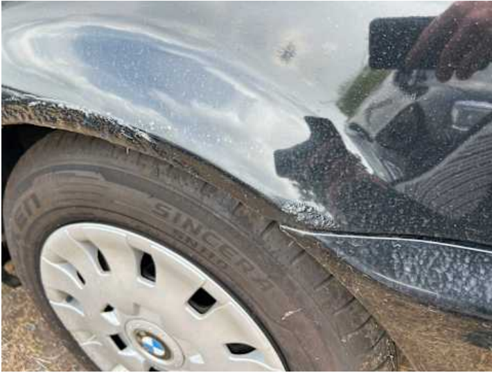
Seitenteil hinten links (Rost)
