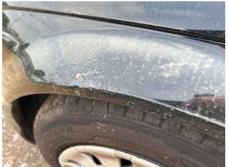
Kotflügel vorne links (Rost)
