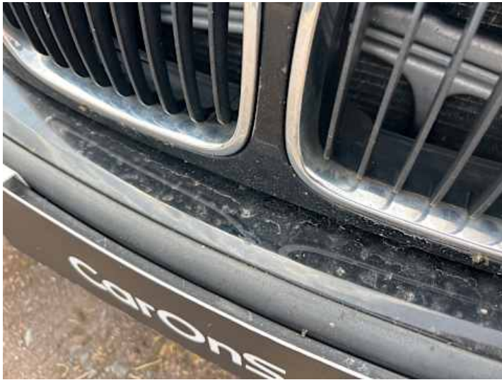
Stoßstange vorne (Lackschaden)
