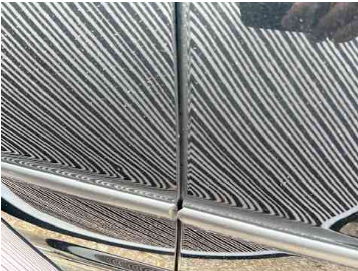
Türe hinten rechts (Delle)
