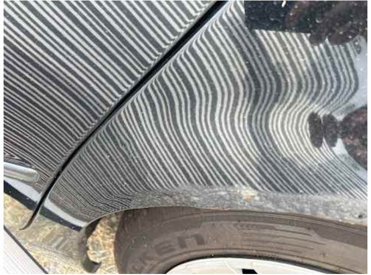
Seitenteil hinten links (Delle)
