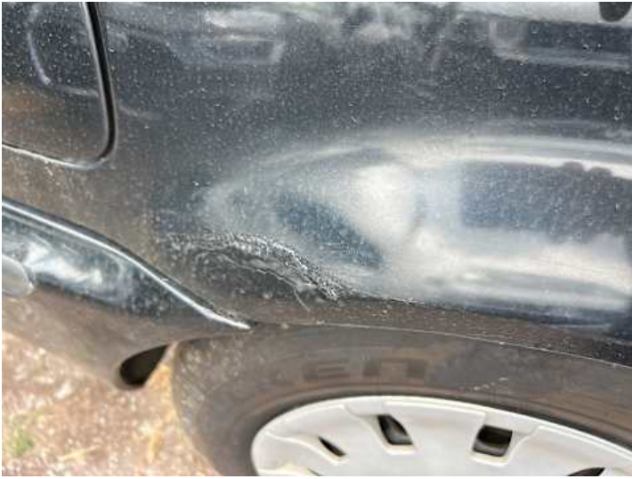
Seitenteil hinten rechts (Rost)
