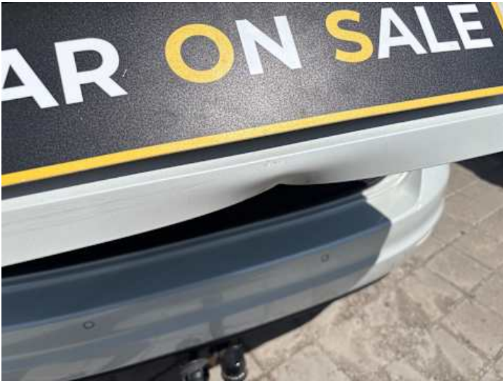
Heckklappe (Verformung, Kratzer)
