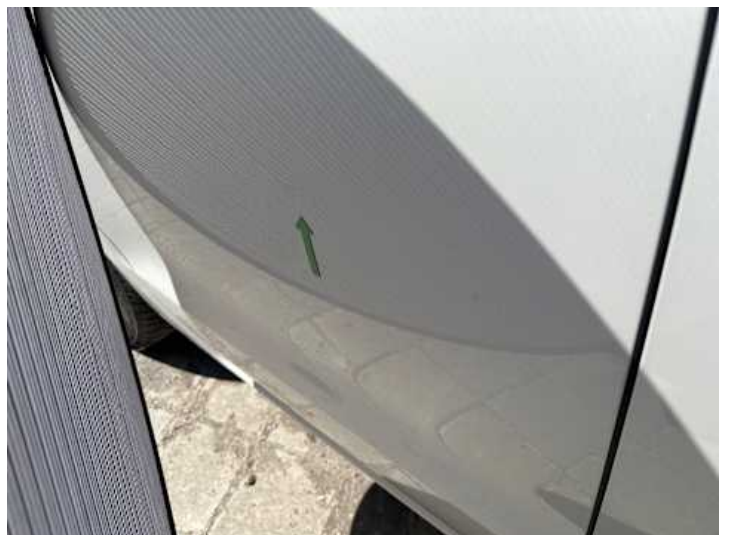
Türe hinten rechts (Kratzer, Delle)
