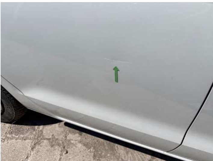
Türe hinten rechts (Kratzer, Delle)
