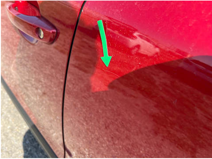
Türe hinten links (Lackschaden, Kratzer)
