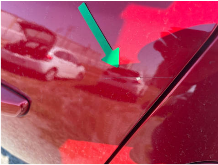
Türe hinten links (Lackschaden, Kratzer)
