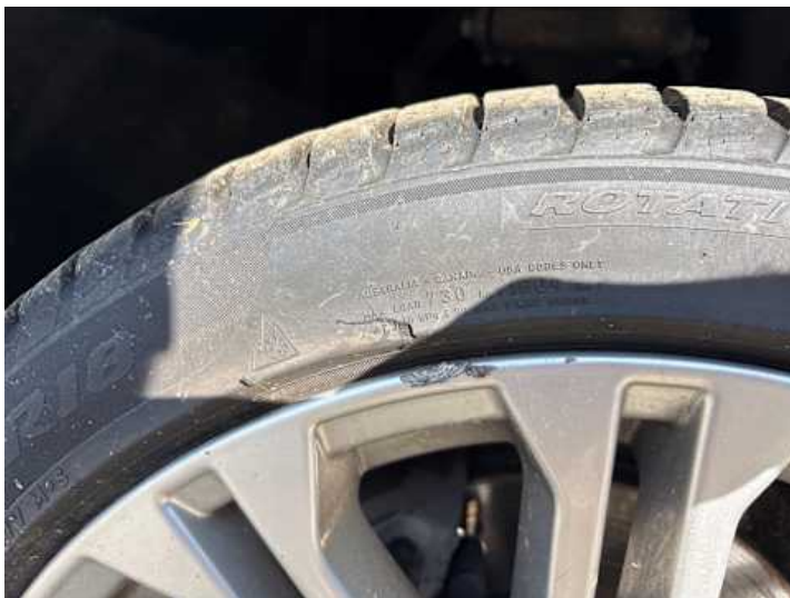
Rad (Kerben, Riss/Bruch)
