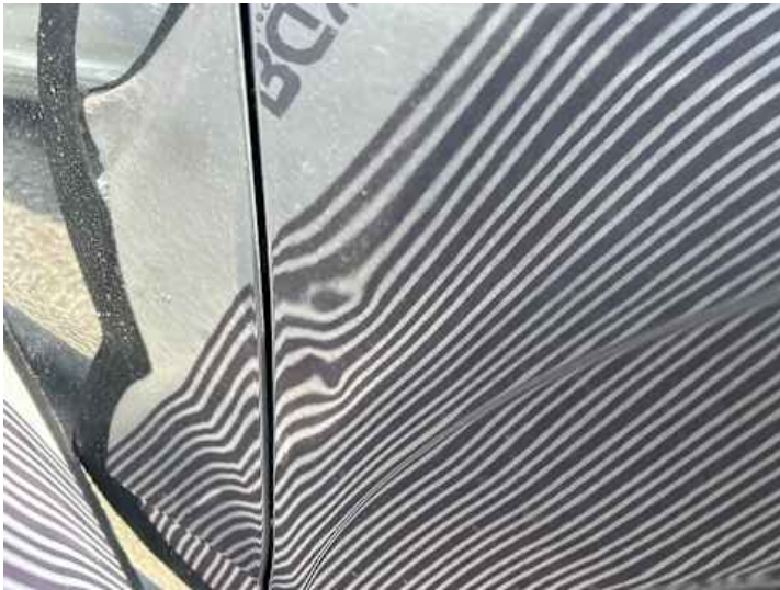
Kotflügel vorne rechts (Verformung)
