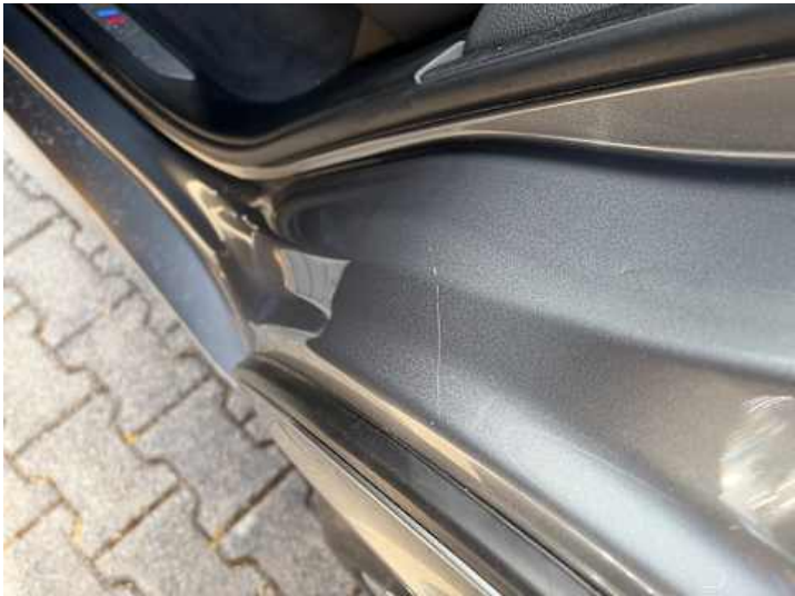
Schweller links (Kratzer)
