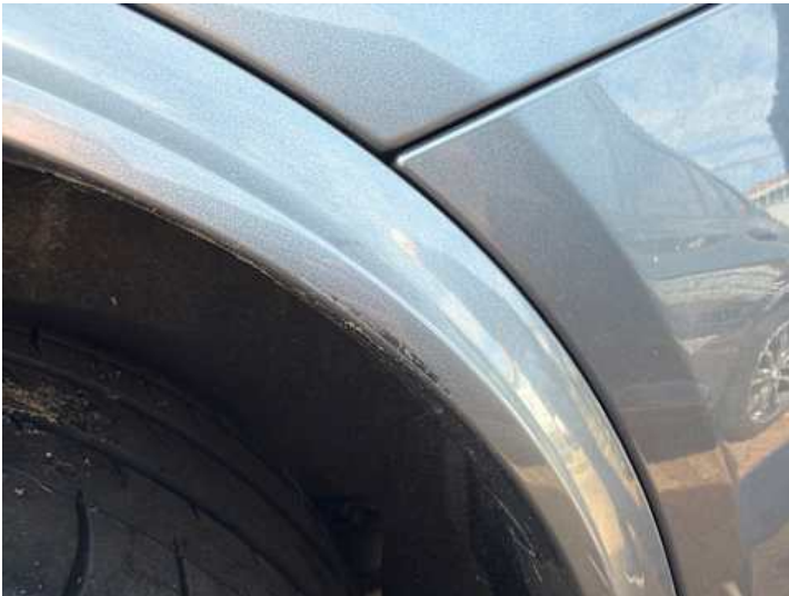
Seitenteil hinten links (Lackschaden)
