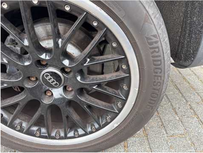
Rad (Kerben, Kratzer, Rost)
