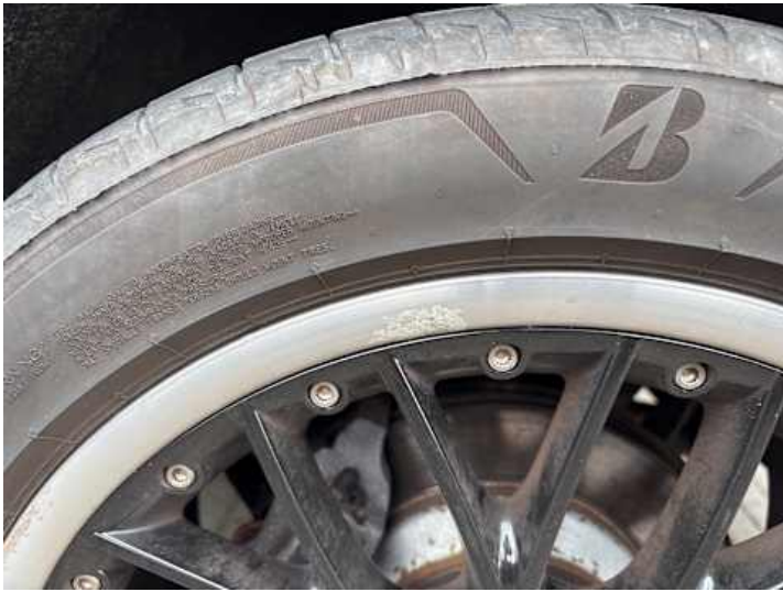
Rad (Kerben, Kratzer, Rost)
