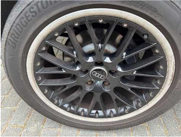
Rad (Kerben, Kratzer, Rost)
