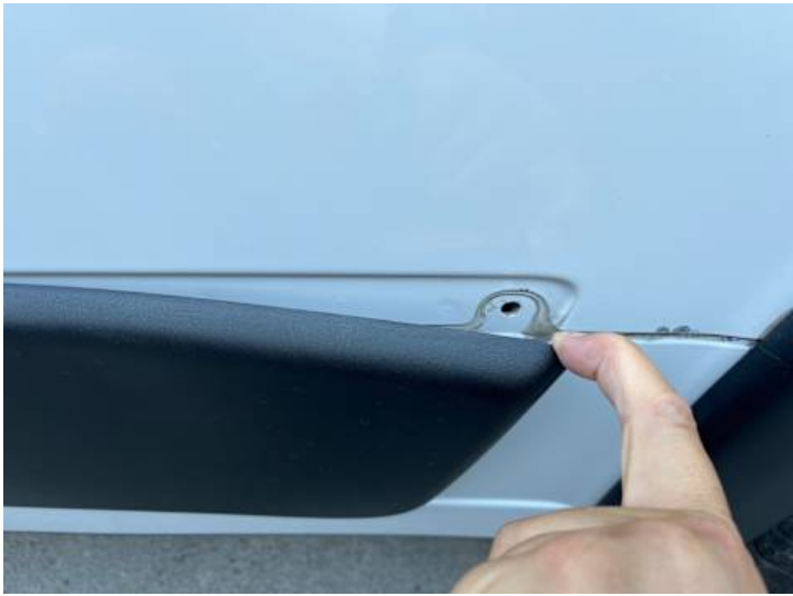
Seitenteil hinten links (Riss/Bruch)
