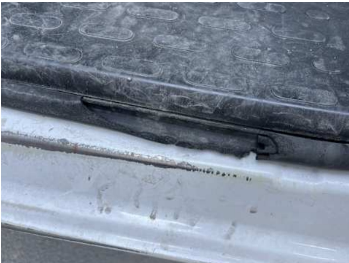
Schweller links (Riss/Bruch)
