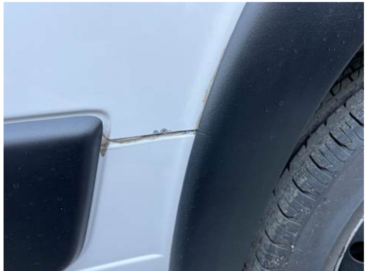
Seitenteil hinten links (Rost)
