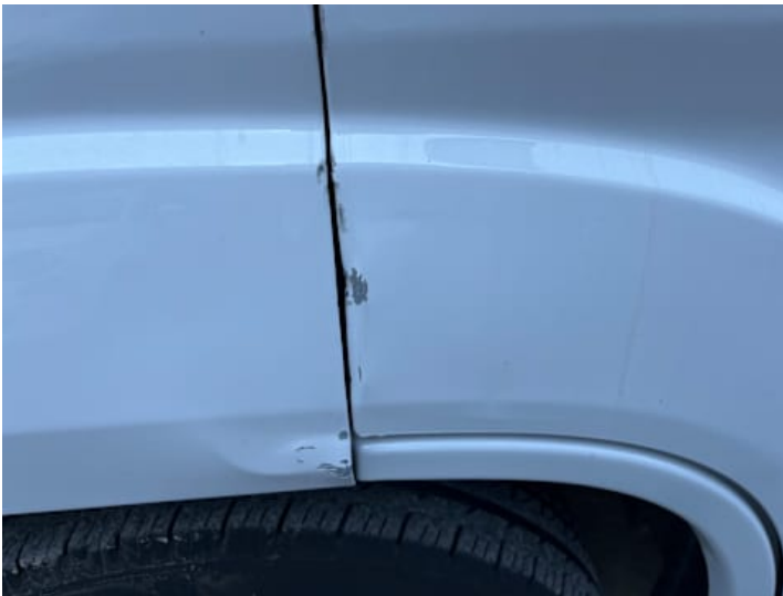
Fahrertür (Delle, Kratzer)
