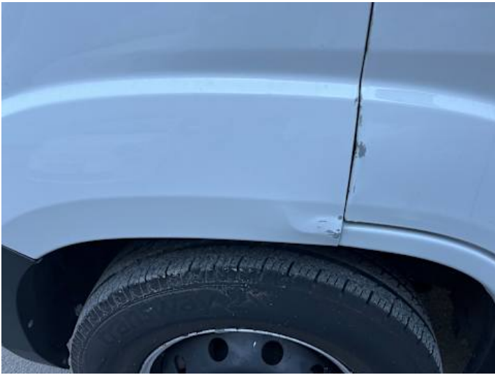
Kotflügel vorne links (Delle, Kratzer)
