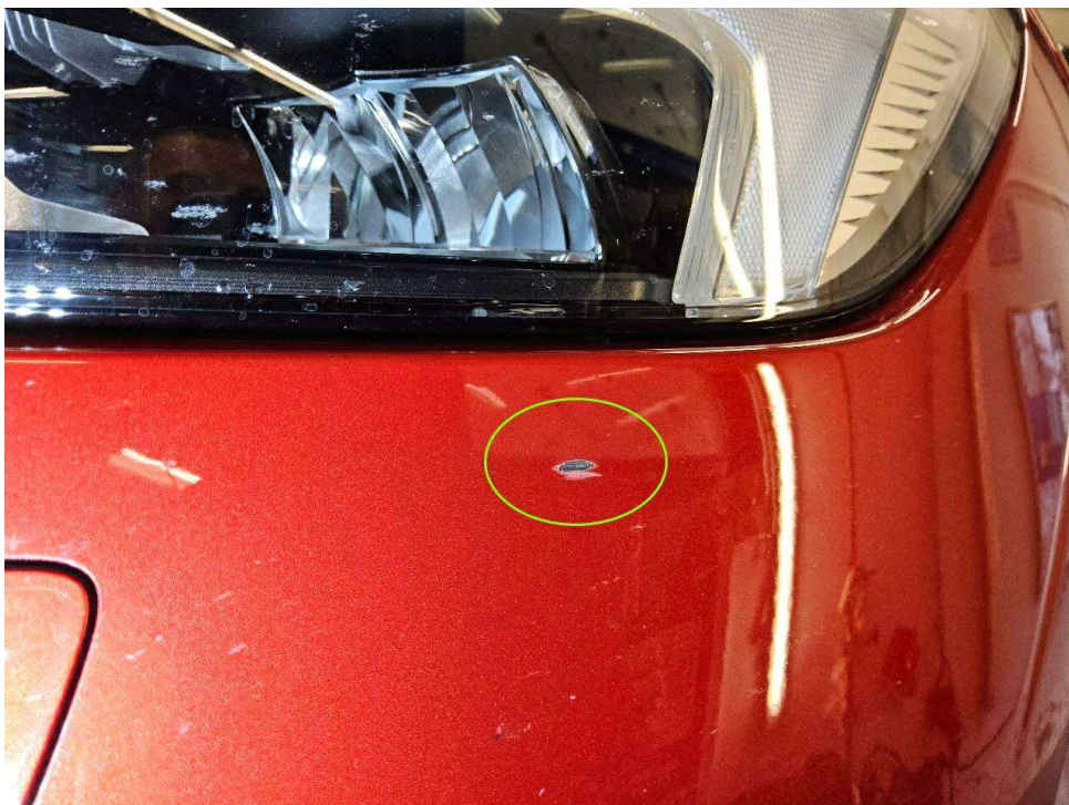
Bild 16 : Stoßfänger vorne leichte Steinschläge und leichte Kratzer, links Schramme, auslegen schleifen und polieren
