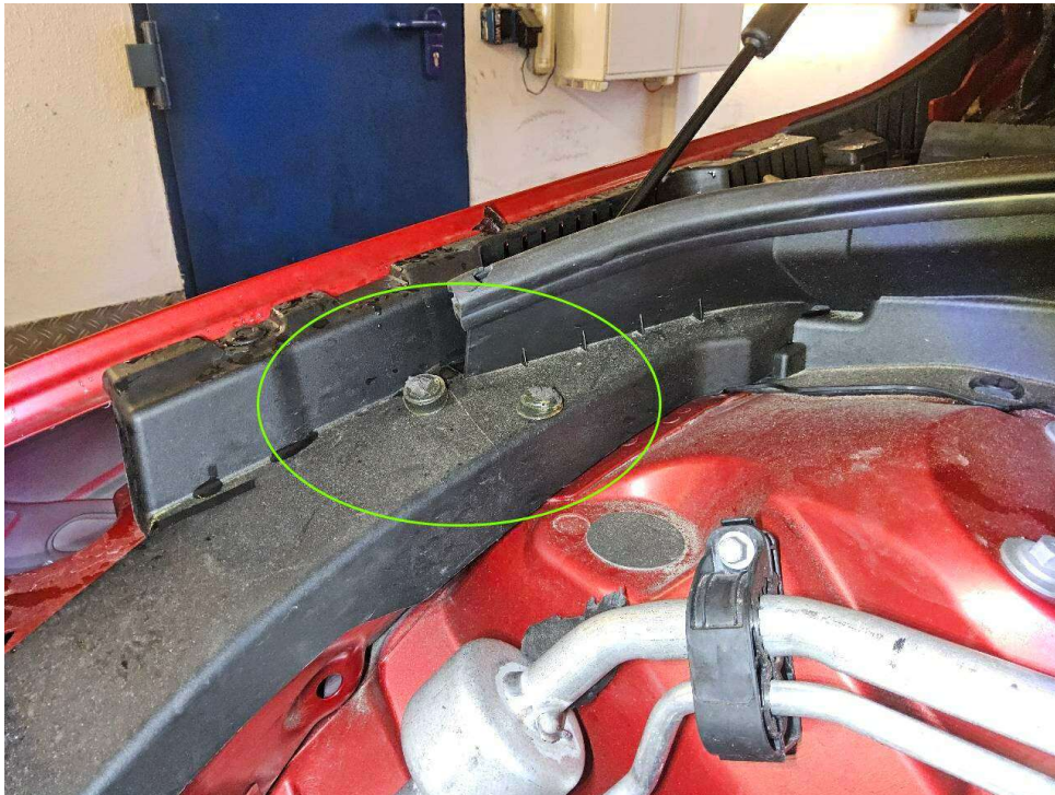
Bild 11 : Motorraumdämmung rechts und links, Motorraum Dichtgummi Tierverbiss
