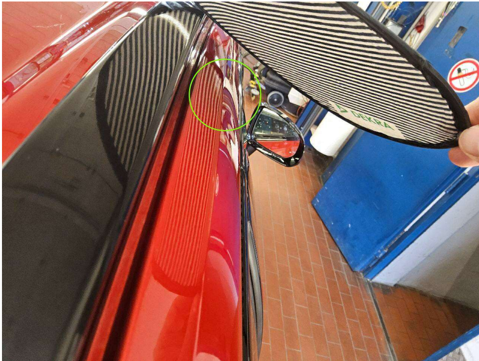
Bild 15 : Dachholm rechts Delle auf der Designkante
