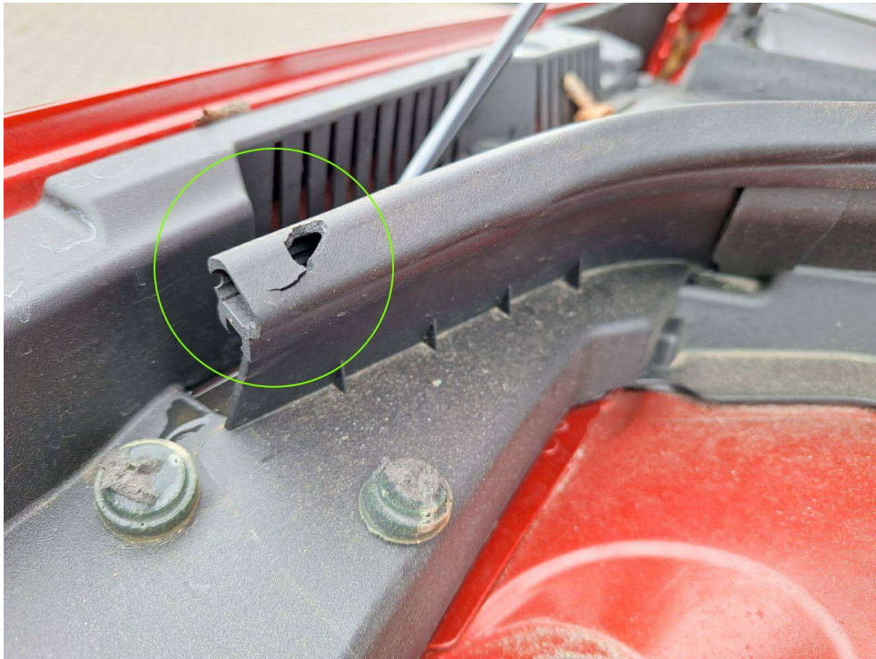
Bild 13 : Motorraumdämmung rechts und links, Motorraum Dichtgummi Tierversbiss
