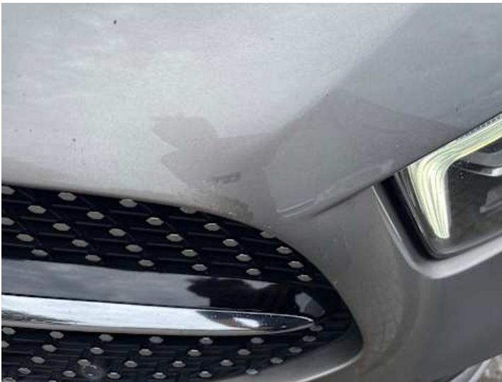
Stoßstange vorne (Unsachgemäß instand gesetzt, Lackschaden)
