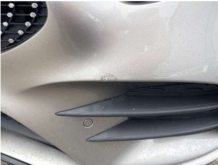
Stoßstange vorne (Unsachgemäß instand gesetzt, Lackschaden)
