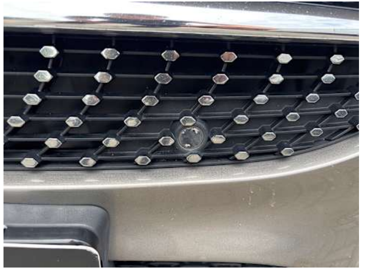
Stoßstange vorne (Unsachgemäß instand gesetzt, Lackschaden)
