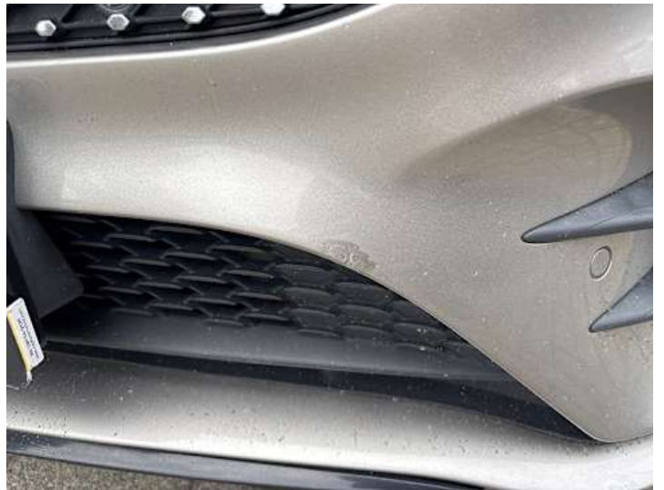
Stoßstange vorne (Unsachgemäß instand gesetzt, Lackschaden)
