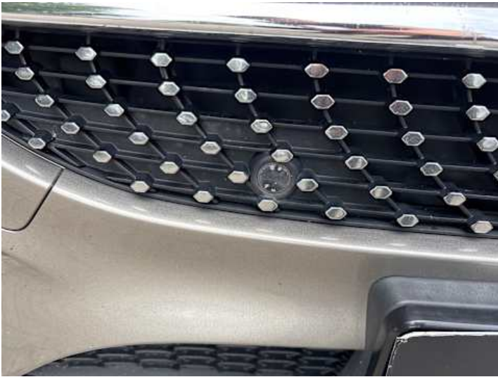
Stoßstange vorne (Unsachgemäß instand gesetzt, Lackschaden)
