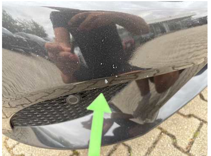
Stoßstange vorne (Steinschlag)
