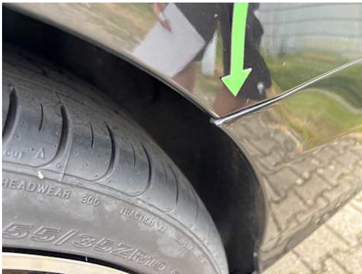
Stoßstange hinten (Spaltmaße ungenau)
