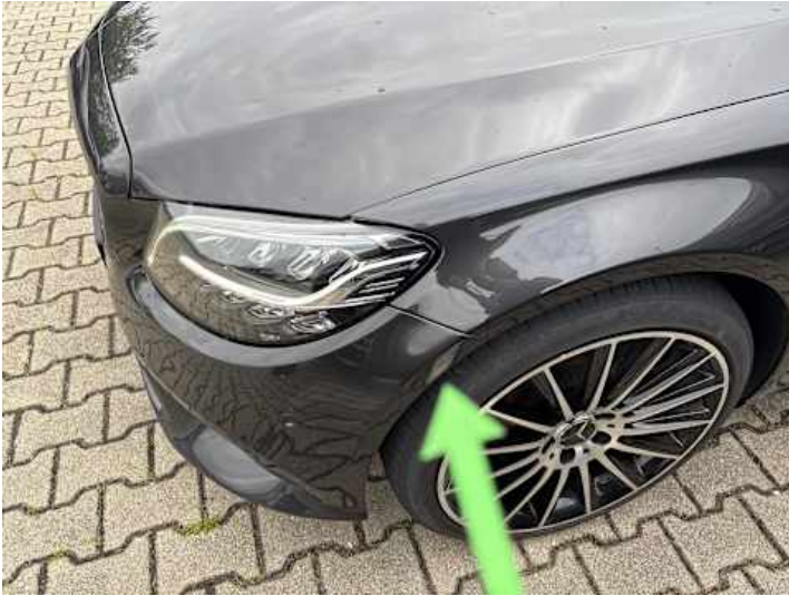
Stoßstange vorne (Spaltmaße ungenau)
