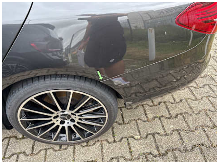
Stoßstange hinten (Spaltmaße ungenau)
