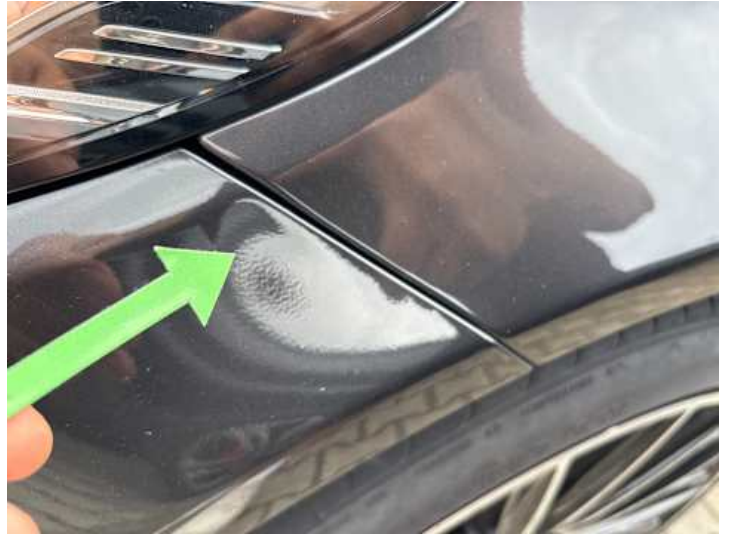
Stoßstange vorne (Spaltmaße ungenau)
