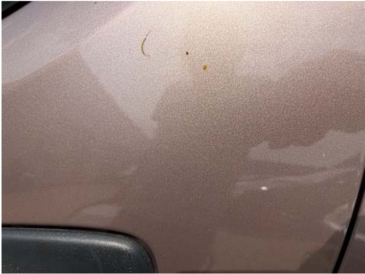
Türe hinten links (Lackschaden, Kratzer)
