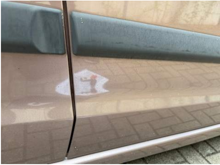
Beifahrtür (Lackschaden, Kratzer)
