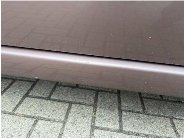
Schweller links (Lackschaden, Kratzer)
