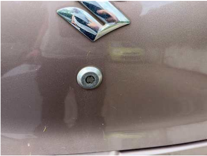
Heckklappe (Lackschaden, Kratzer)
