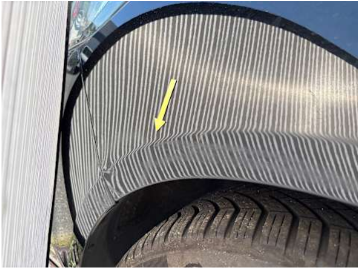
Kotflügel vorne links (Kratzer, Verformung)
