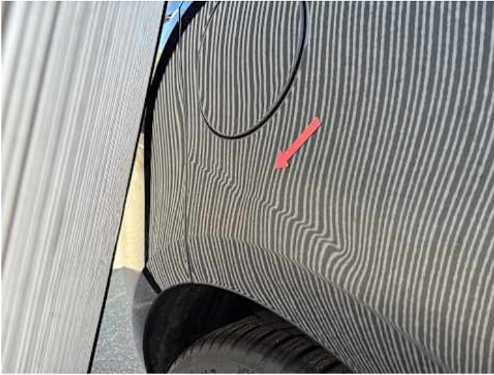
Seitenteil hinten rechts (Verformung, Lackschaden)
