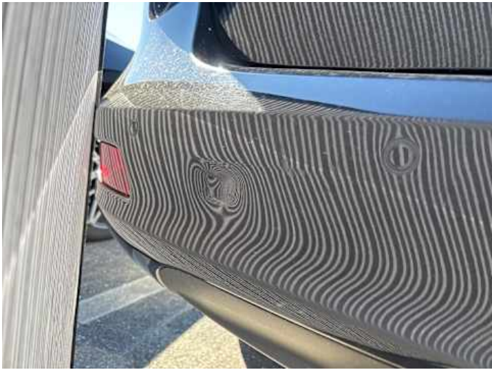
Stoßstange hinten (Verformung, Lackschaden)
