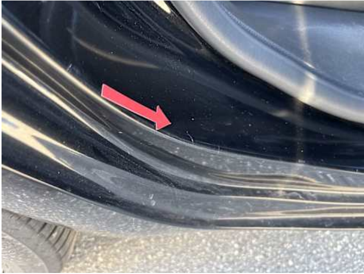
Schweller rechts (Kratzer)
