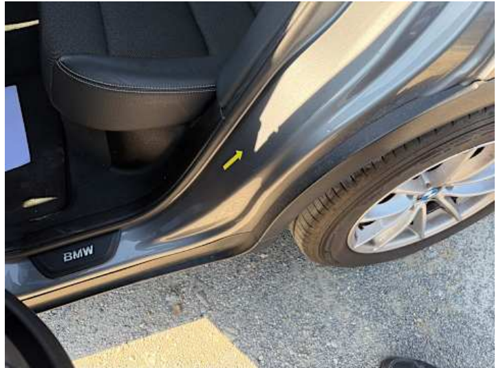
Türe hinten links (Kratzer, Delle)
