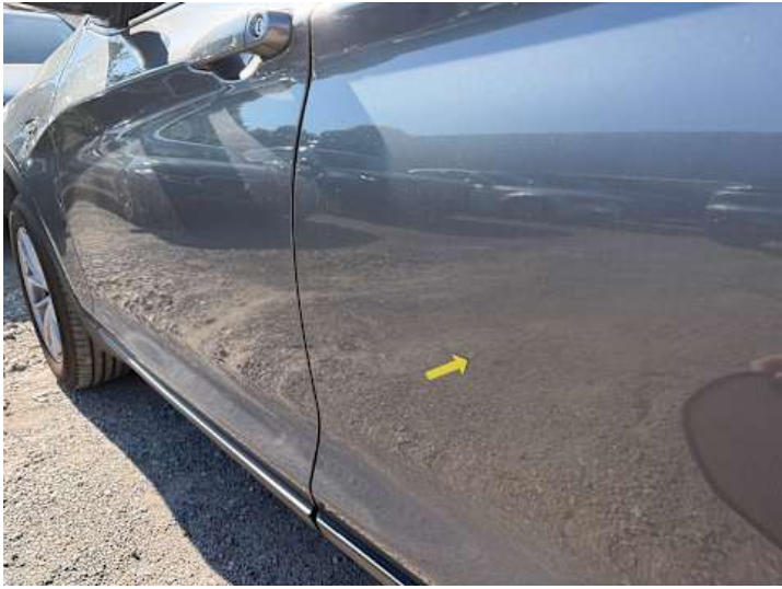
Türe hinten links (Kratzer, Delle)
