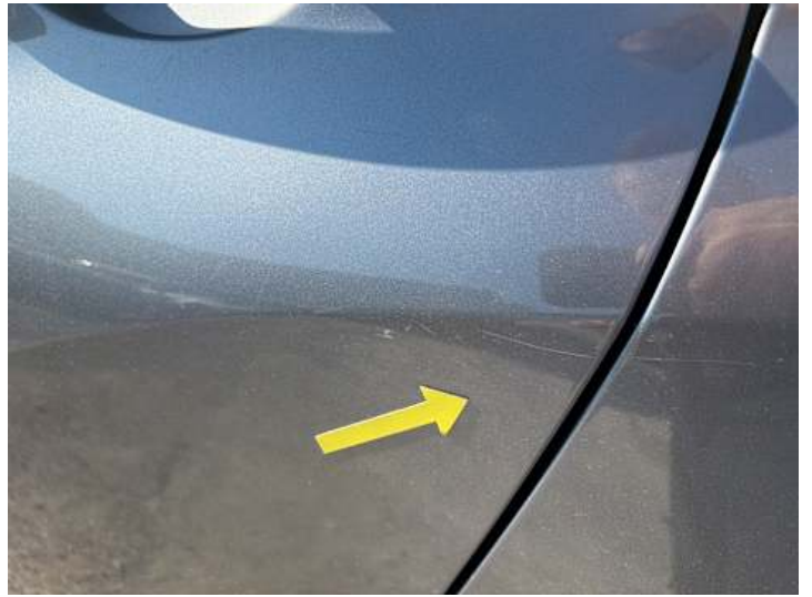
Türe hinten links (Kratzer, Delle)
