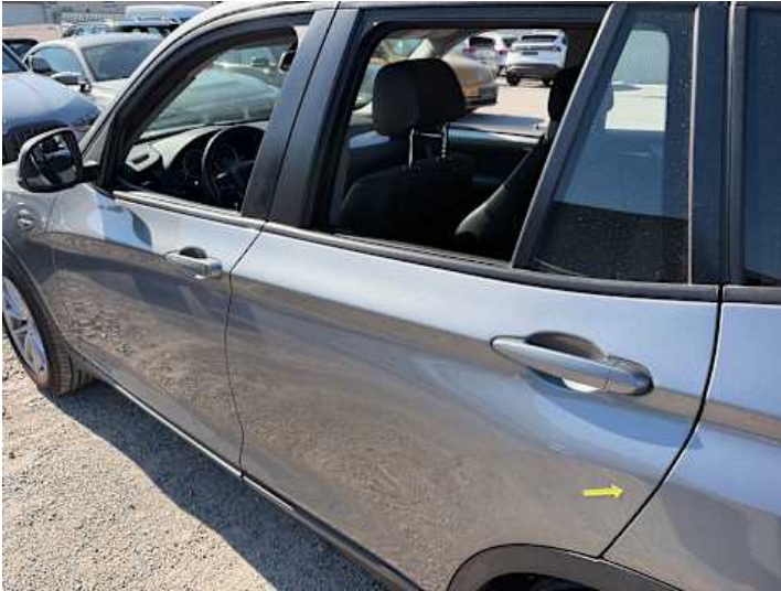
Türe hinten links (Kratzer, Delle)
