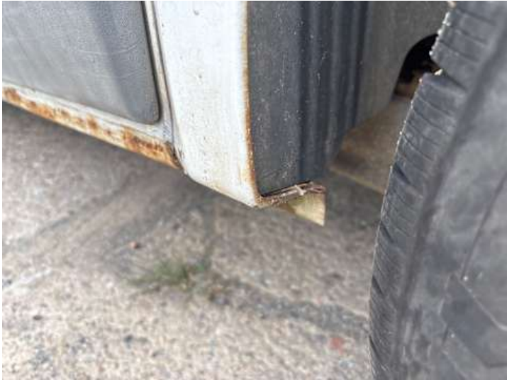
Seitenteil hinten links (Delle, Lackschaden, Rost)
