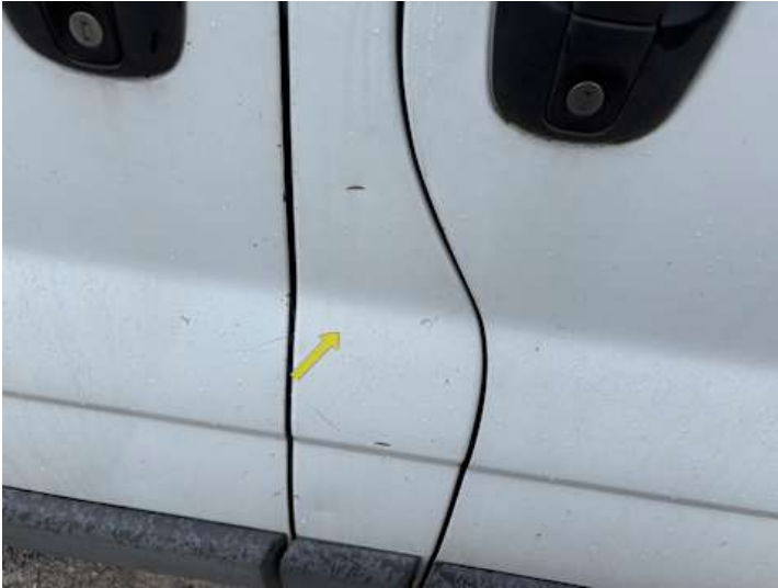
Schweller rechts (Lackschaden)
