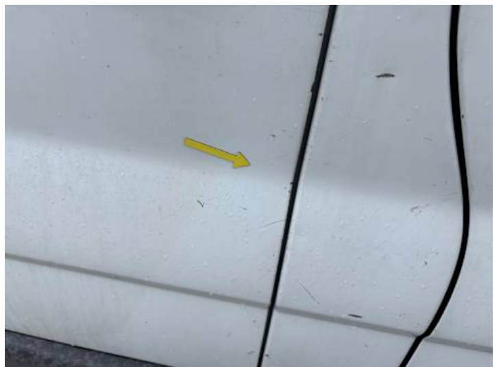
Türe hinten rechts (Lackschaden, Rost)
