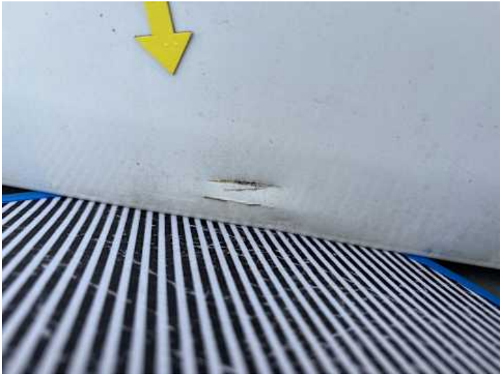
Heckklappe (Delle, Kratzer, Lackschaden, Rost)
