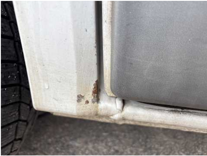
Seitenteil hinten rechts (Lackschaden, Rost, Kratzer)
