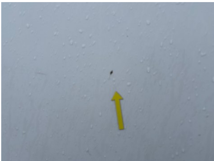
Türe hinten rechts (Lackschaden, Rost)
