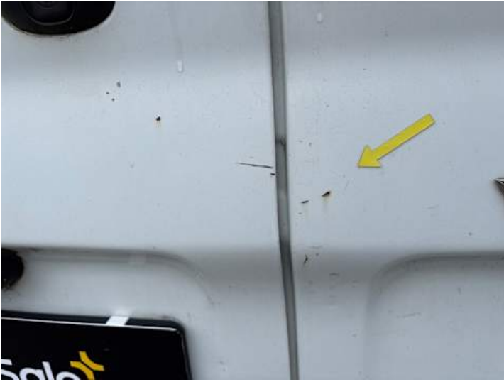
Heckklappe (Delle, Kratzer, Lackschaden, Rost)
