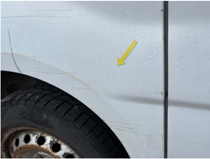
Seitenteil hinten rechts (Lackschaden, Rost, Kratzer)
