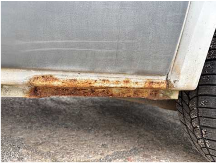
Schweller links (Rost)
