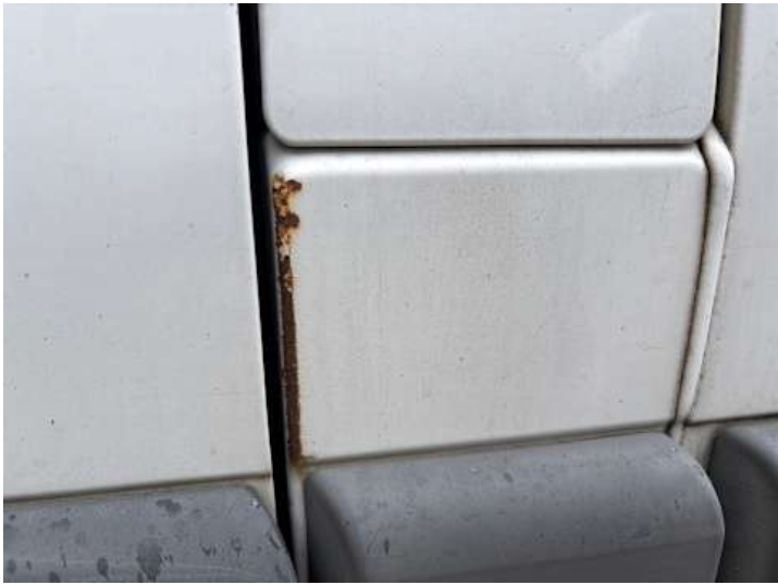
Schweller links (Rost)
