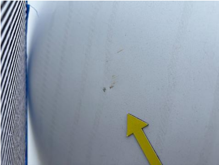
Seitenteil hinten links (Delle, Lackschaden, Rost)
