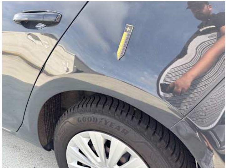
Seitenteil hinten links (Unsachgemäß instand gesetzt)
