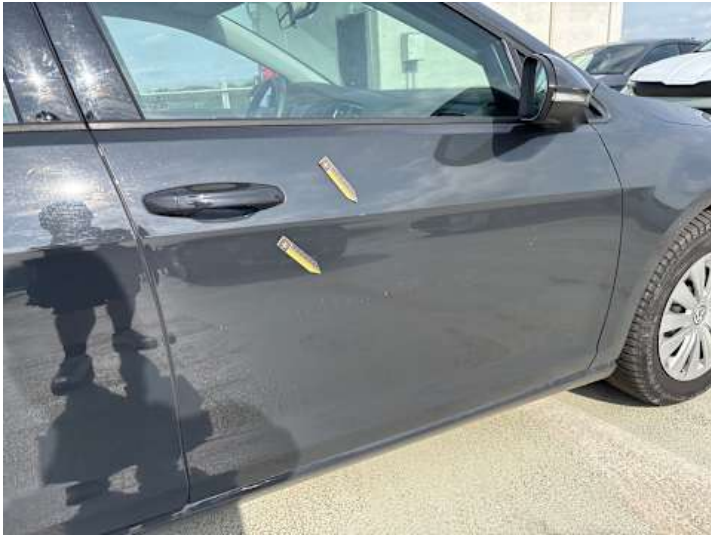
Beifahrtür (Lackschaden, Kratzer)
