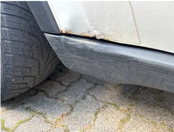
Türe hinten rechts (Verformung, Rost)
