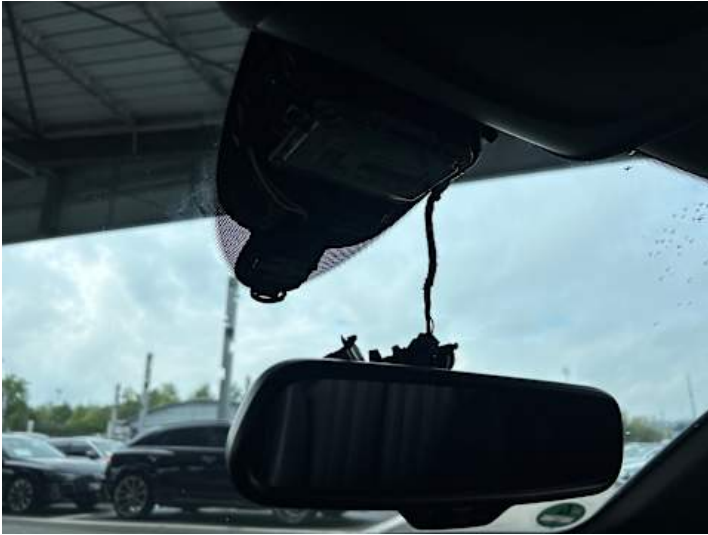
Innenraum (Anderer Schaden): Rückspiegel Halterung defekt
