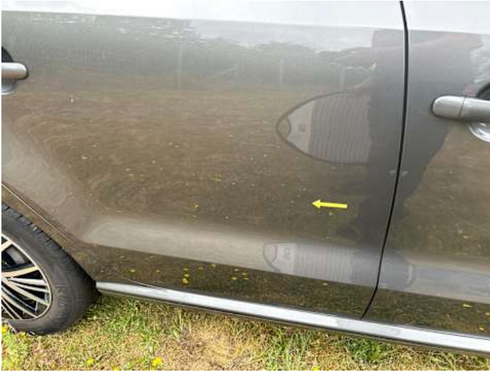
Türe hinten rechts (Delle)
