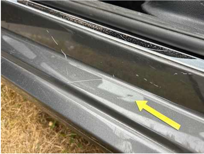
Schweller links (Lackschaden)
