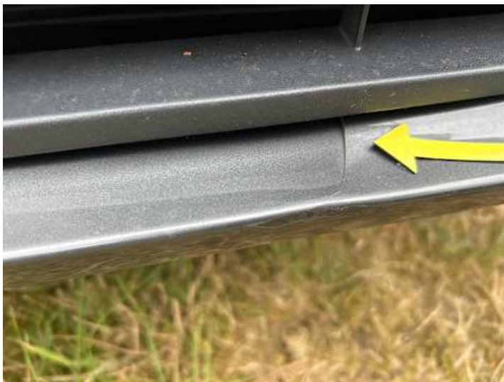
Stoßstange vorne (Riss/Bruch)
