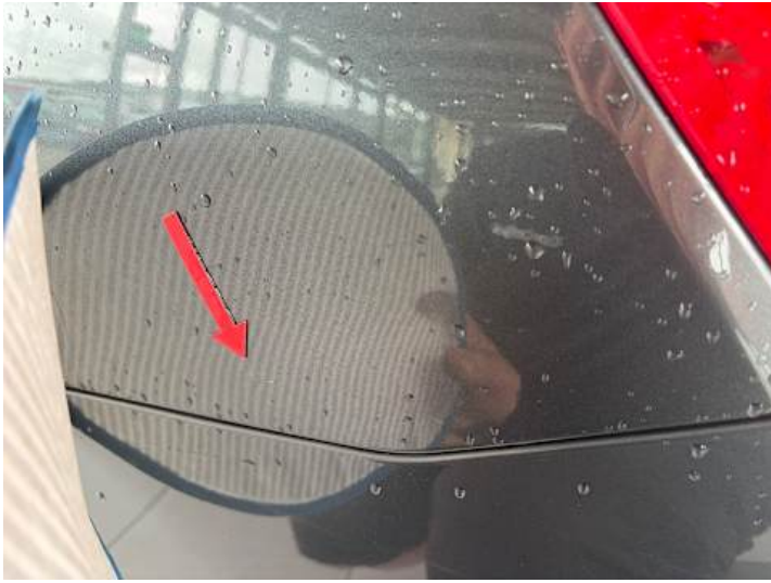
Seitenteil hinten links (Kratzer, Delle)
