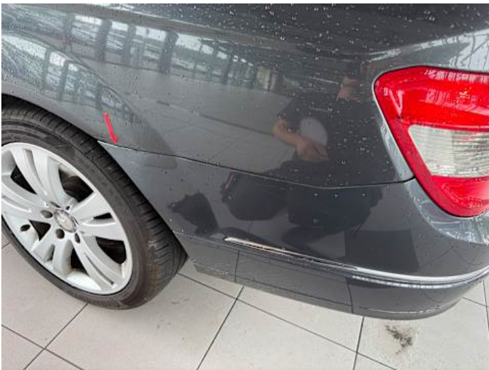
Stoßstange hinten (Kratzer, Lackschaden)
