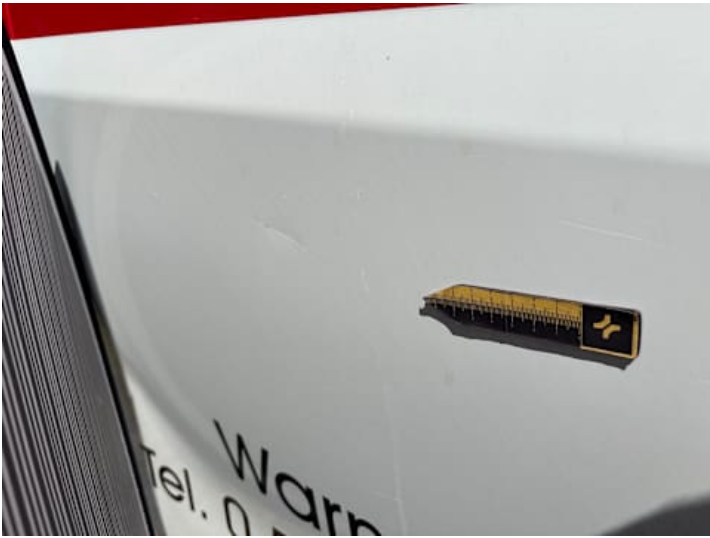
Türe hinten rechts (Lackschaden, Delle, Kratzer)
