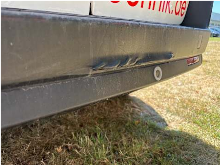
Stoßstange hinten (Riss/Bruch)
