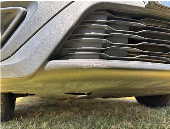
Stoßstange vorne (Lackschaden)
