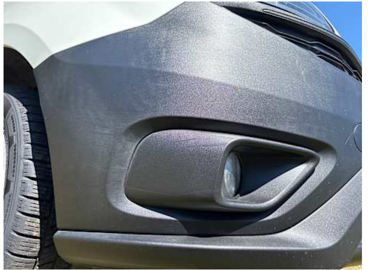
Stoßstange vorne (Lackschaden)
