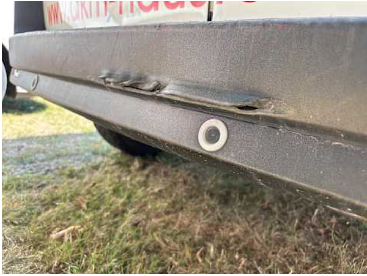
Stoßstange hinten (Riss/Bruch)
