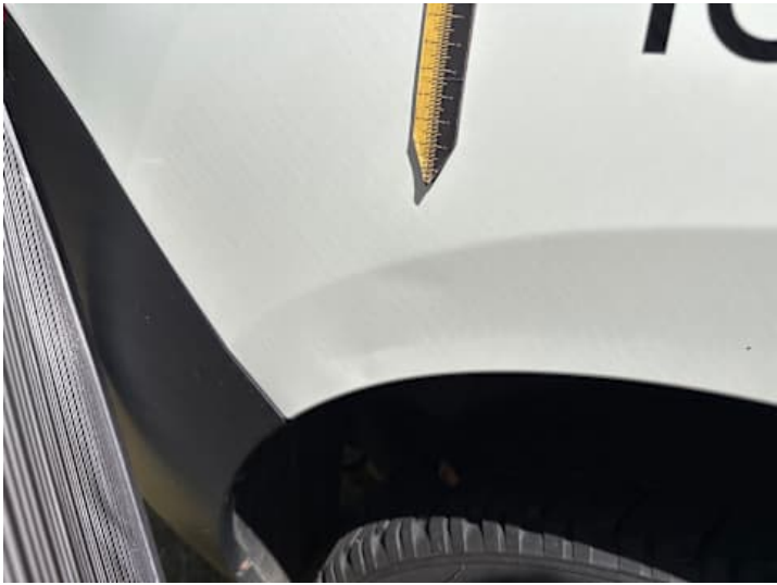
Seitenteil hinten rechts (Lackschaden, Verformung)
