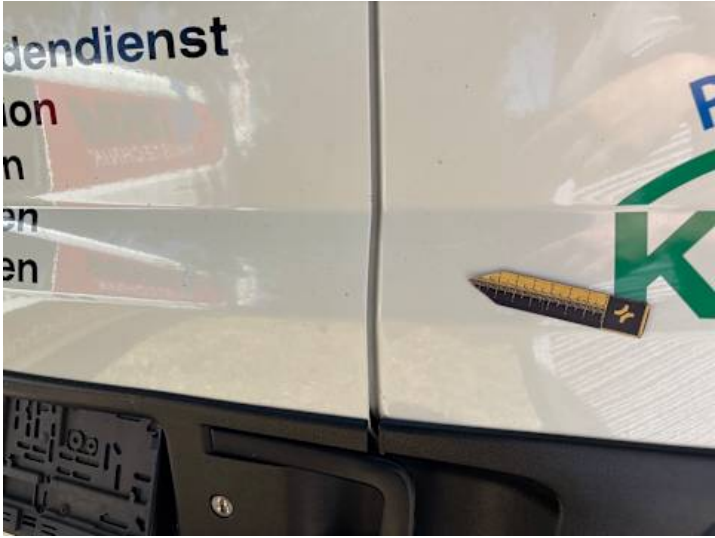
Heckklappe (Kratzer, Lackschaden)
