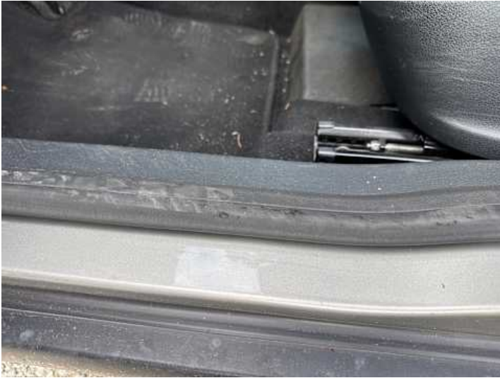
Innenraum (Verschleiß, Riss/Bruch)
