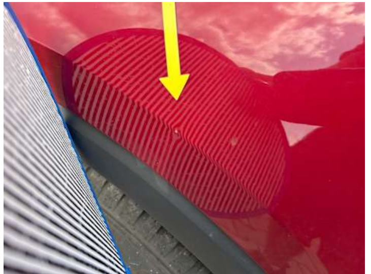
Kotflügel vorne links (Delle, Kratzer)
