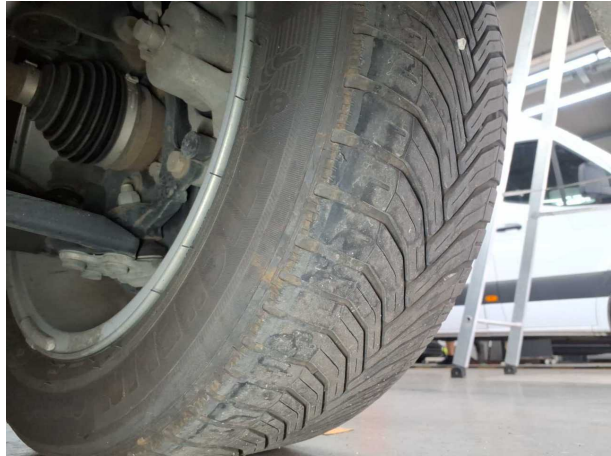
Rad/Reifen: Reifen vorn (205/60R16) - verschlissen - erneuern
