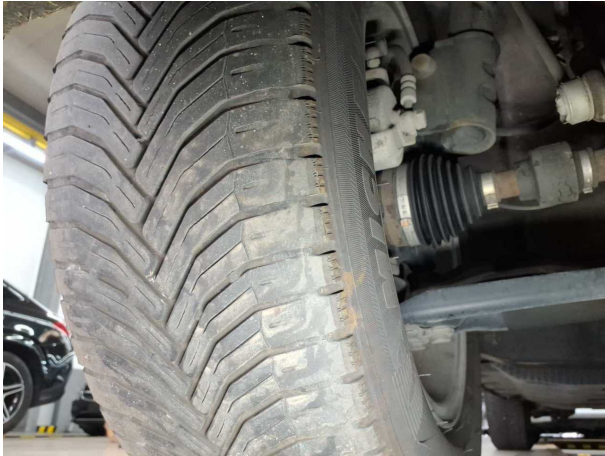
Rad/Reifen: Reifen vorn (205/60R16) - verschlissen - erneuern
