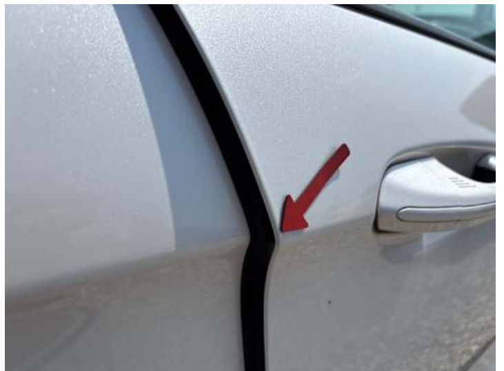
Beifahrertür (Lackschaden, Kratzer)
