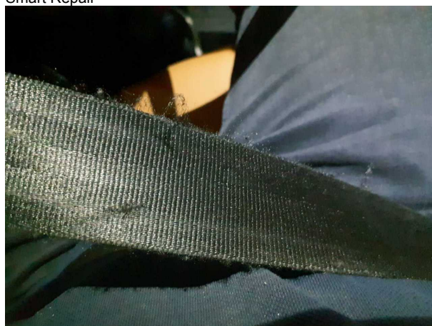
Beschädigung 4: Gurtsystem vorn: Sicherheitsgurt vorn link... porös / rissig - erneuern
