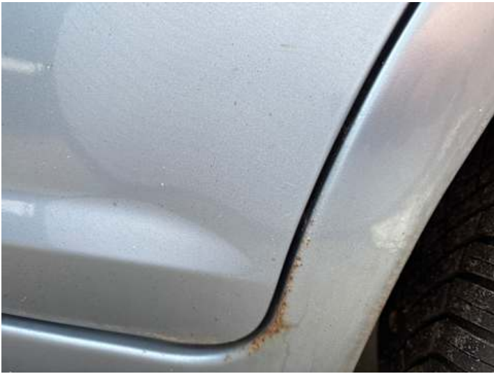
Seitenteil hinten links (Rost)
