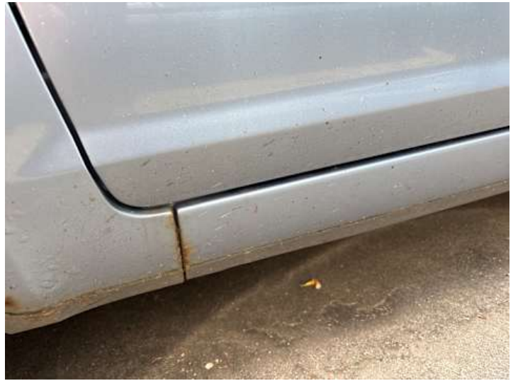
Schweller links (Rost)
