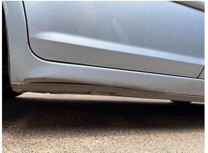
Schweller rechts (Verformung, Rost)
