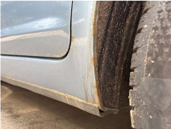
Schweller links (Rost)
